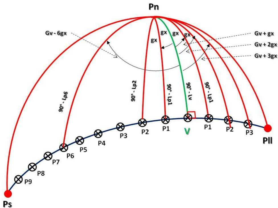
Fig. N° 12 (“Puntos en que la diferencia de longitud entre puntos es constante”).
