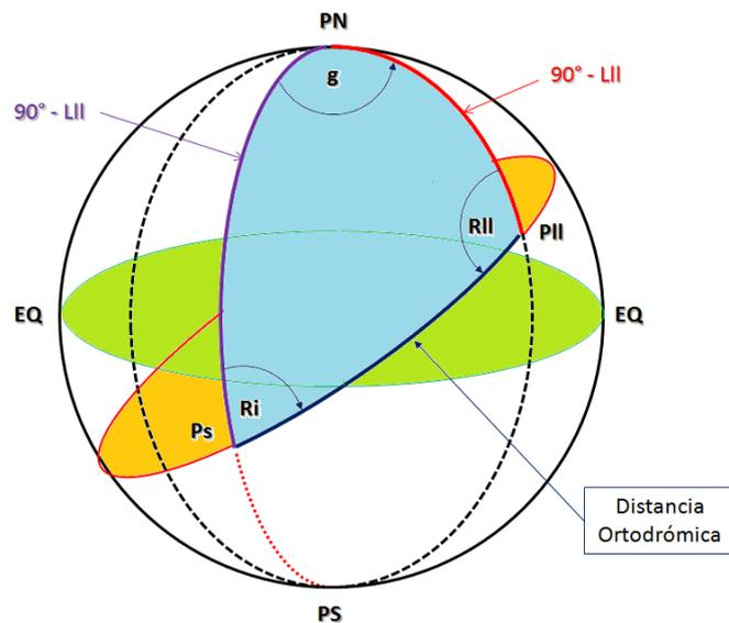
Fig N° 3 ("El Triángulo ortodrómico")
