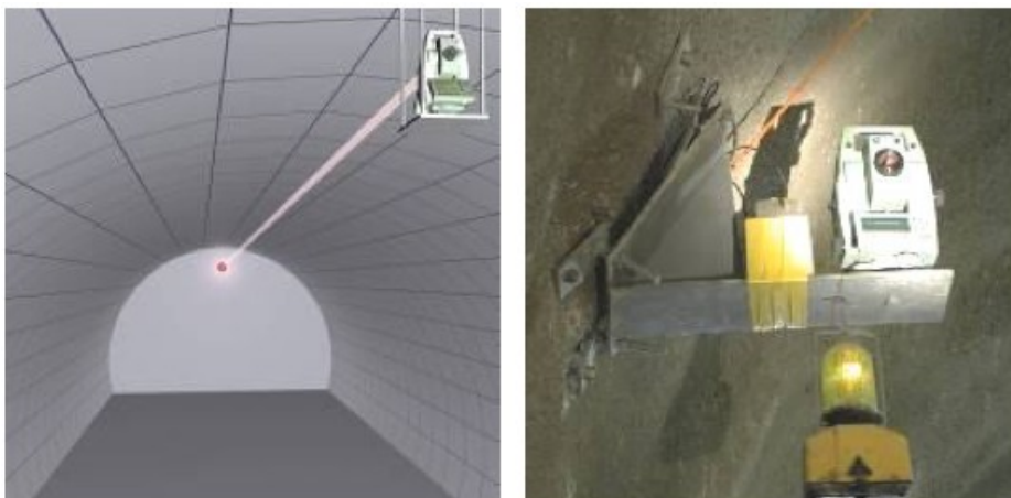
Σχήμα 4.9: Χάραξη άξονα σήραγγας.
