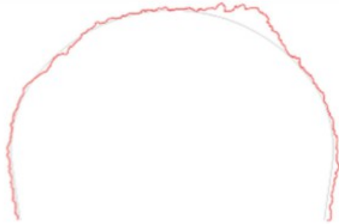
Σχήμα 3.4: Εκσκαφή (κόκκινο χρώμα) σε σύγκριση με την τυπική γραμμή εκσκαφής (μαύρο χρώμα).
