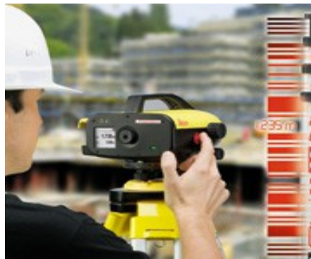
Σχήμα 2.4: Χρήση ψηφιακού χωροβάτη κατά την διαδικασία γεωμετρικής χωροστάθμισης.
