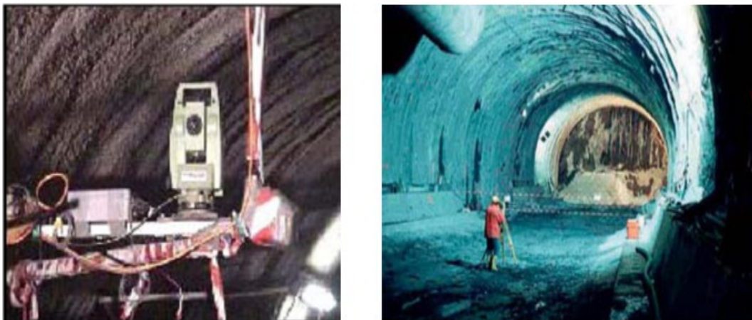
Σχήμα 2.27: Παρακολούθηση των παραμορφώσεων σήραγγας με χρήση γεωδαιτικού σταθμού.
