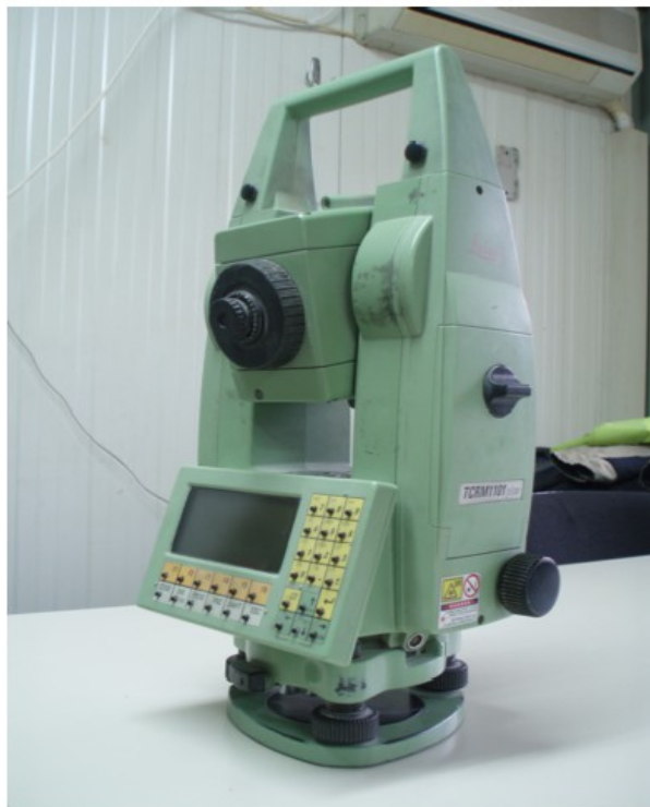
Σχήμα 4.12: Ο γεωδαιτικός σταθμός τύπου Leica TCRM 1101 Plus.
