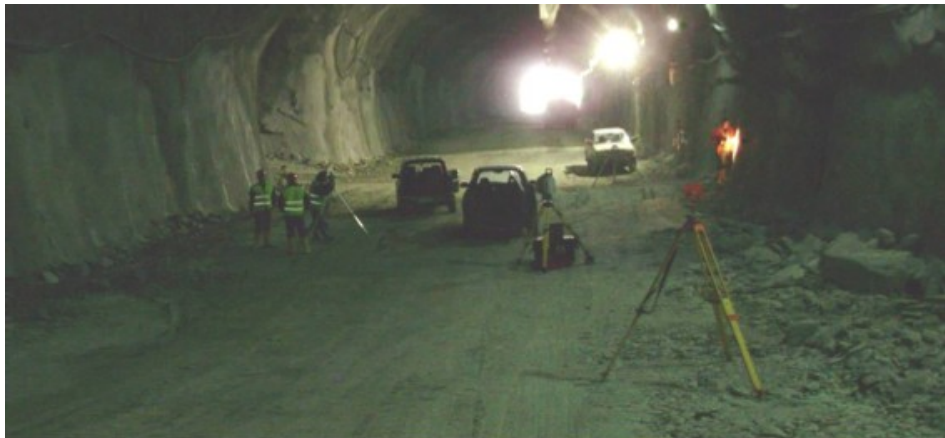
Σχήμα 4.25: Προσανατολισμός επίγειου σαρωτή laser.
