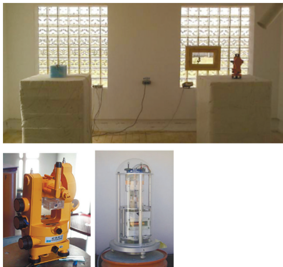
Рисунок 4.2 - Немагнитный павильон для абсолютных измерений обсерватории (вверху). Форточка в правом окне предназначена для наблюдения мира, а труба в правом верхнем углу – для наблюдения полярной звезды. Магнитный теодолит и вариометр (внизу)
