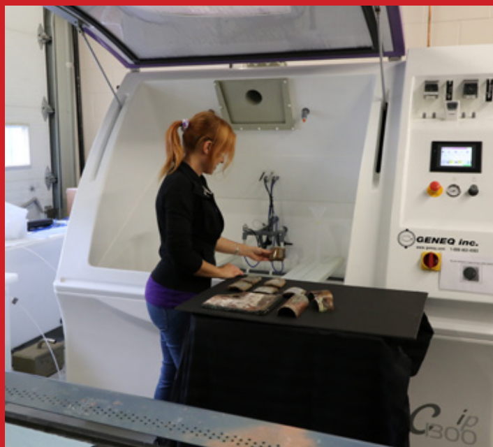
Essai de corrosion - brouillard salin
