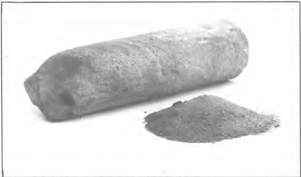
Figur 14. Injeksjon i løsmasser. Foto av borkjerne av siltig sand permeert av akryl sammen med ubehandlet siltig sand. Borkjernen har diameter 47 mm og er tatt ut i det området testinjeksjonen ble utført. De mørke fragmentene er biter av kull.
