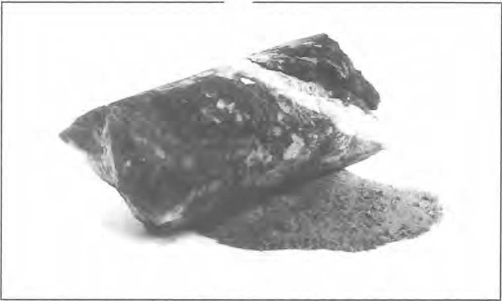
Figur 10. Injeksjon i svakt berg. Foto av borkjerne med injisert sprekk uten bergkontakt. Sprekken har mottatt injeksjonsmasse i to omganger og har fremdeles fylling av leire på flere mm. Det vises en åpen kanal på sprekken i underkant av injeksjonsmassen (lyst lag). Kjernediameteren er 47 mm.
