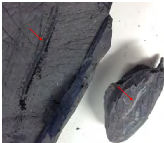
Figur 5: Uforvitret alunskifer til venstre med kullsort strek, vanlig mørk skifer til høyre med grå strek.
