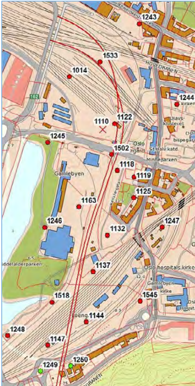
Figur 2 Målepunktene for poretrykk som Bioforsk overvåker for Jernbaneverket i tilknytning til Follobanen Innføring Oslo S. Grønne punkter er piezometer i berg, røde punkter står i løsmasser. Ref. http://bioweb07.bioforsk.no/follobanen_grunnvann/
