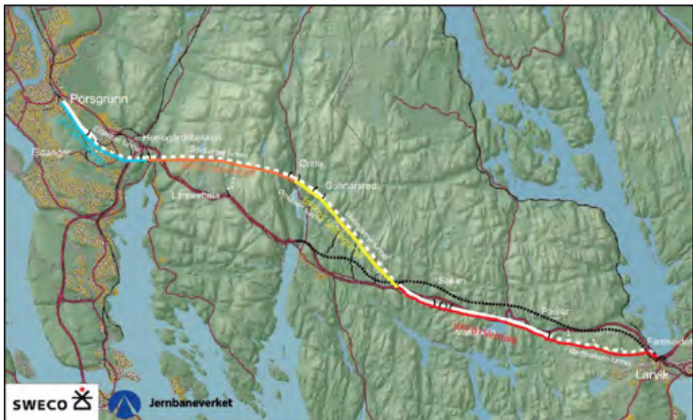
Figur 1. Inndeling av grunnentrepriser i prosjektet. UFP08 – Implenia (turkis), UFP07 – NCC (orange), UFP05 – Veidekke (gul), UFP01 – Skanska (rød).
