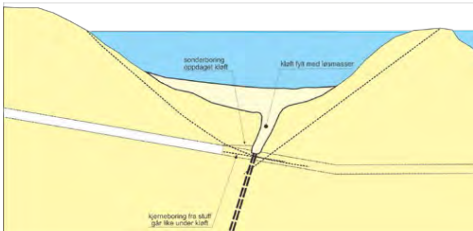
Figur 12: Utførelse av sonderboringer med tunnelriggen oppdaget at forkastningen var erodert til en dyp kløft som endte midt i tunnelen
