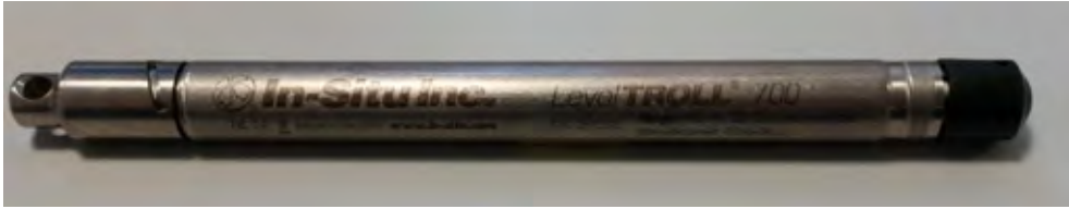
Figur 8: Trykksensor og datalogger som registrerer det overførte trykket fra "flat jack".
