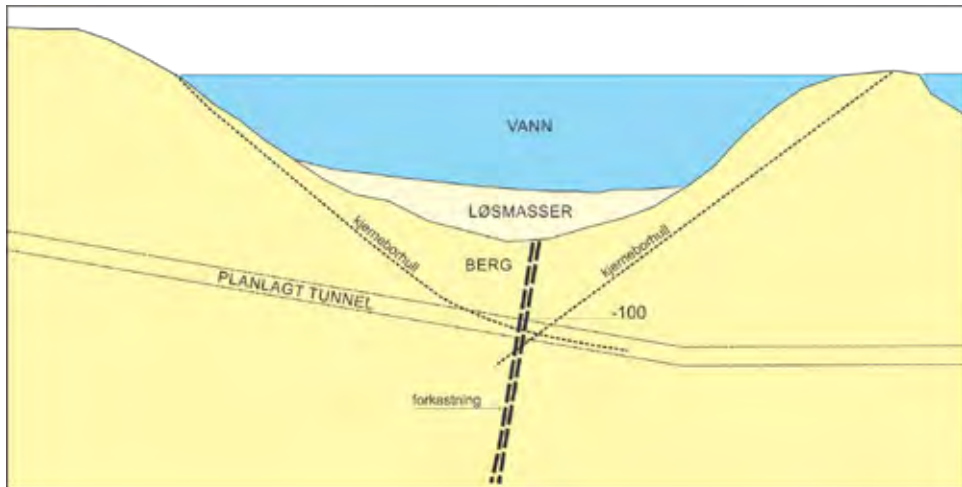
Figur 11: Boringer og tolkning av grunnforholdene. I tillegg til boringene ble det utført refraksjonsseismikk
