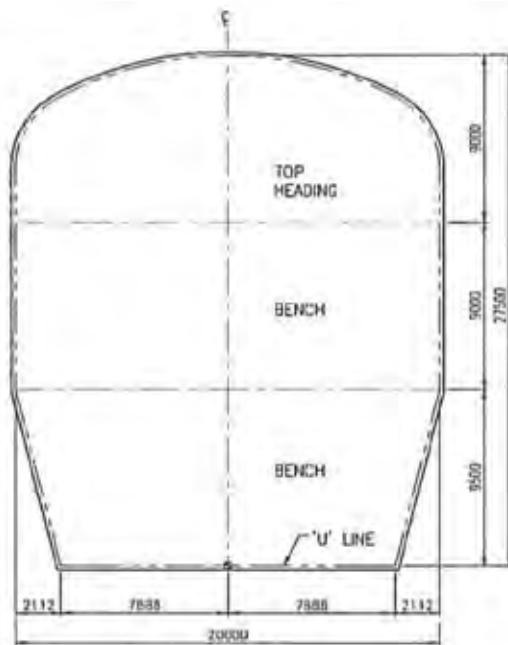
Figur 8 Typisk tverrsnitt for berghallene (Tee et al. 2012)
