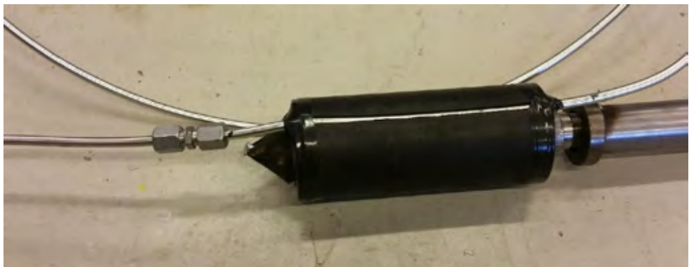
Figur 7: Nærbilde av pakker med \frac{1}{4} stålrør som overfører trykk fra "flat-jack" til logger.
