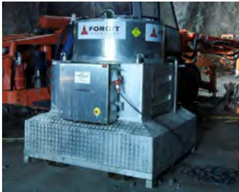
Figur 3-Forcit Laddenhet 201 och laddning med slangdragare i TASJ.
