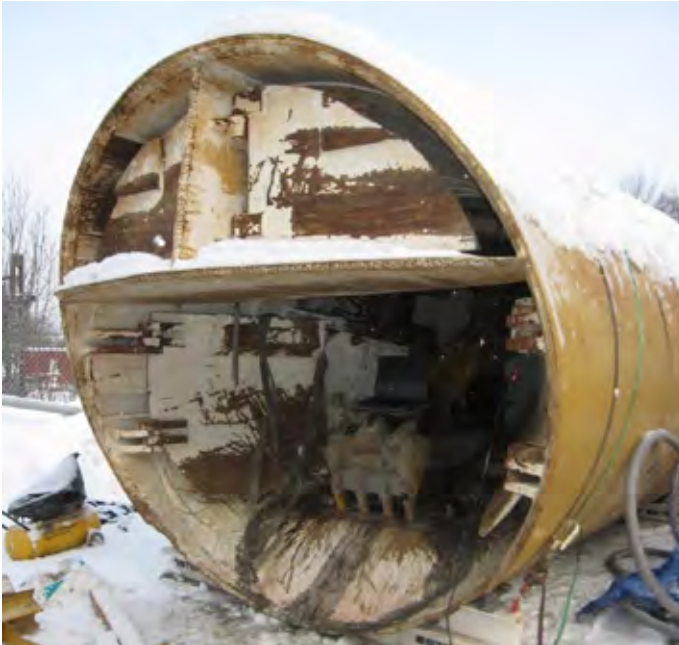
Figur 25 Fronten på den største maskinen. For innvendig rørdiameter 2,4 m. Merk skuffen på gravemaskinen og portene som kan stenges. Merk også den skråstilte fronten og den horisontale "skilleplaten". Frontens retning styres vha. fire sylindreljeker .
