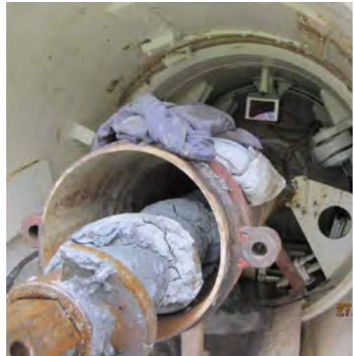
Figur 3 b Samme maskin sett "innenfra". Merk skrue og innerrør der massene transporteres.
