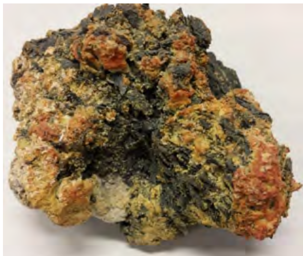
Figur 4: Eksempel på forvitret alunskifer med kraftig sulfatoppblomstring.
