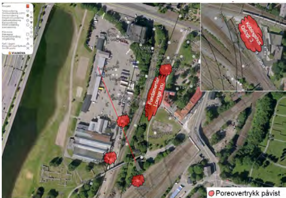
Figur 3 Registrert lekkasje fra borhull, poreovertrykk i poretrykksmålere og område hvor det var funnet poretrykk for Loenga bru på 1960-tallet.
