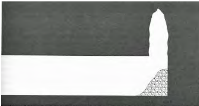
Figur 13: Tunnelmasser ble fylt inn på stuff mens raset utviklet seg mer enn 10 m oppover. Med begrenset fjelloverdekning ble håndtering av raset spennende (fra Karlson, 2008).
