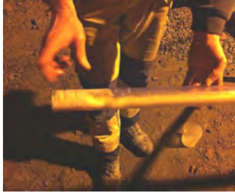
Figur 4-Kalibrering av laddutrustningen med hjälp av plexiglasrör.
