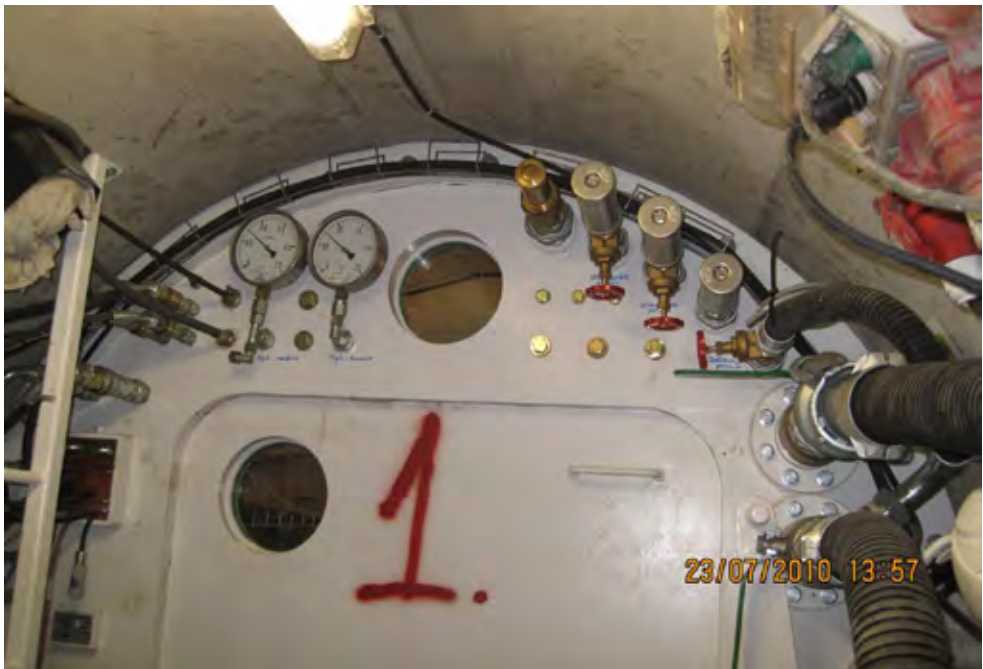
Figur 29 Trykkluse sett utenfra. Overtrykket er 0,7 bar, eller 70 \text{ kN/m}^2 .
