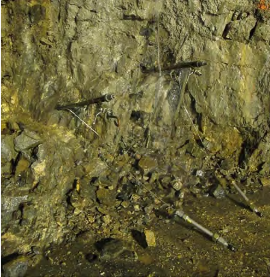
Figur 10: Loggerenheter som via 1/4"rør gjennom sliss i pakkeren registrerer data fra trykksensoren
