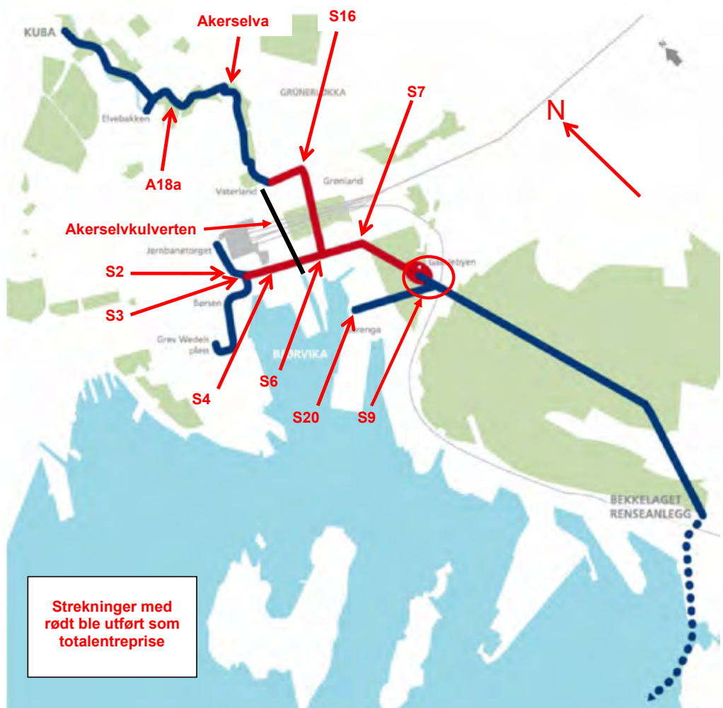
Figur 1 Oversiktskart over indre Oslofjord med traseer for Midgarsormen. Fra Kuba i nord til Bekkelaget renseanlegg i sør er det ca. 5 km i luftlinje. Traseen for Akerselvkulverten er forenklet. I sjakt S9 går Midgarsormen over fra løsmasser til bergtunnel. Illustrasjon: VAV/Norconsult.
