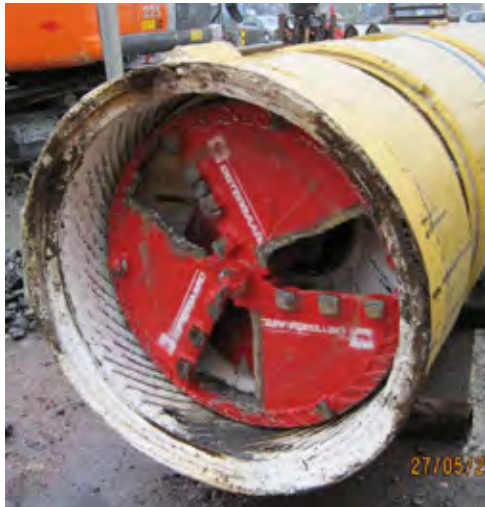
Figur 3 a Front på maskin benyttet til GRP-rør. Roterende kutter med åpninger. Man ser også trakten inn mot innerrøret. Rørdiameter 1030 mm.
