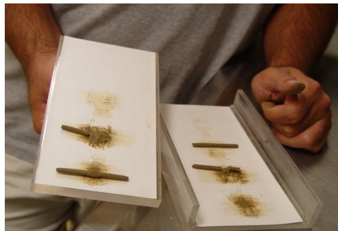
3. kép: A sodrasi határ meghatározása Forrás: Szlávik L. szerk. (2018): Vízkarrelhárítási, kézikönyv, OVF, p. 841. 5. fejezet
