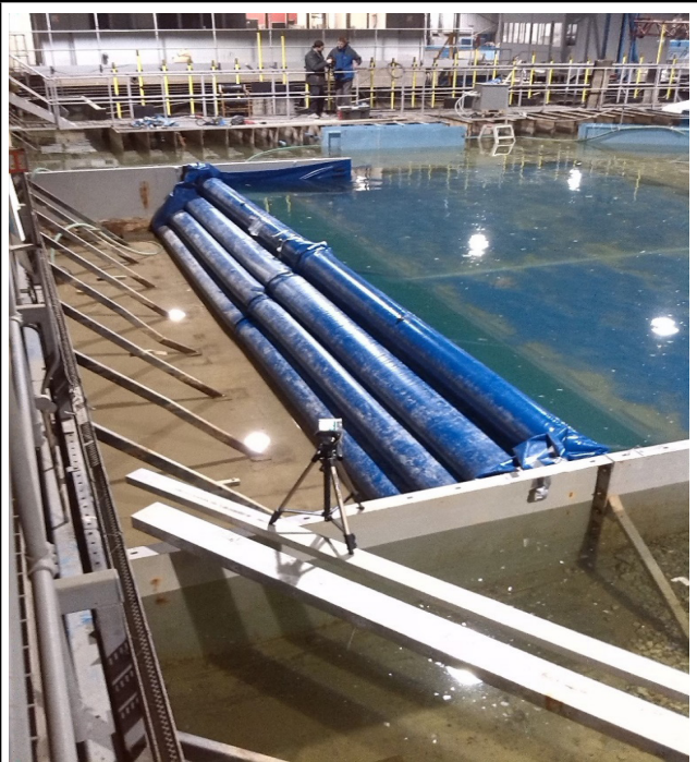
20/b. kép: BME Geotechnikai Tanszék által tervezett „Inflater” mobil árvízvédelmi gát az ellenőrző méréseken
