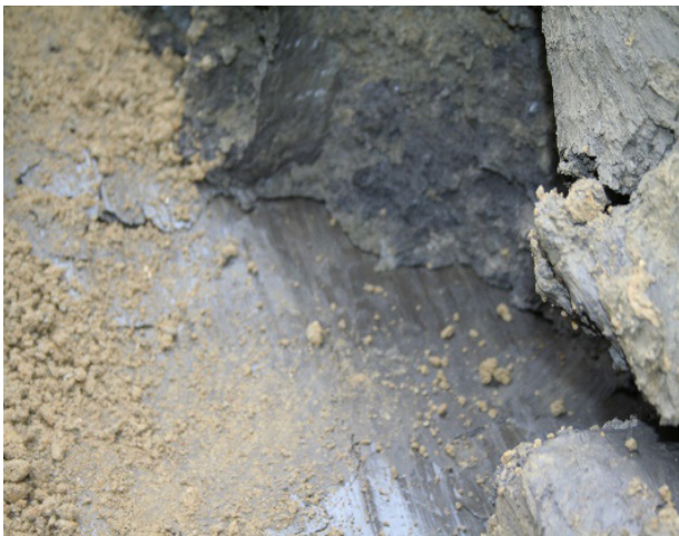
22. kép: A csúszólap fényes felülete és a csúszólapon kialakuló repedés. A kép bal oldalán látható sárga agyag szemcsék a kiátsáskor peregték a munkagödörbe. Hármaskörös j.p., Istvánházi suvadás, KÖTIVIZIG
