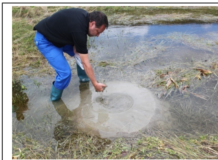
98. kép: Mintavétel a buzgárból, a buzgár kúpjának lehetőleg mindkét oldala képviseltesse magát a mintában
