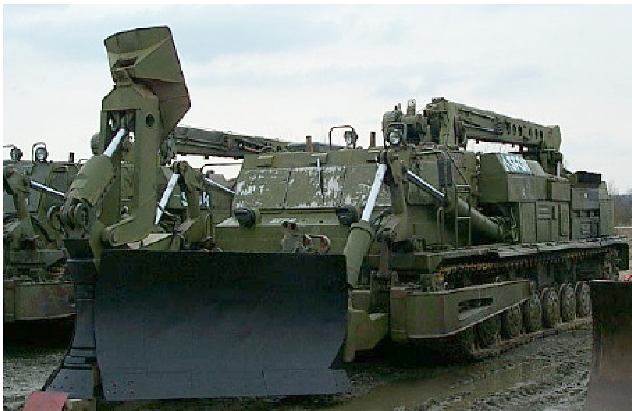
3. sz. kép: BAT-2 gyorsjáratú lánc talpas bulldózer Forrás: a szerző saját készítésű felvétele
