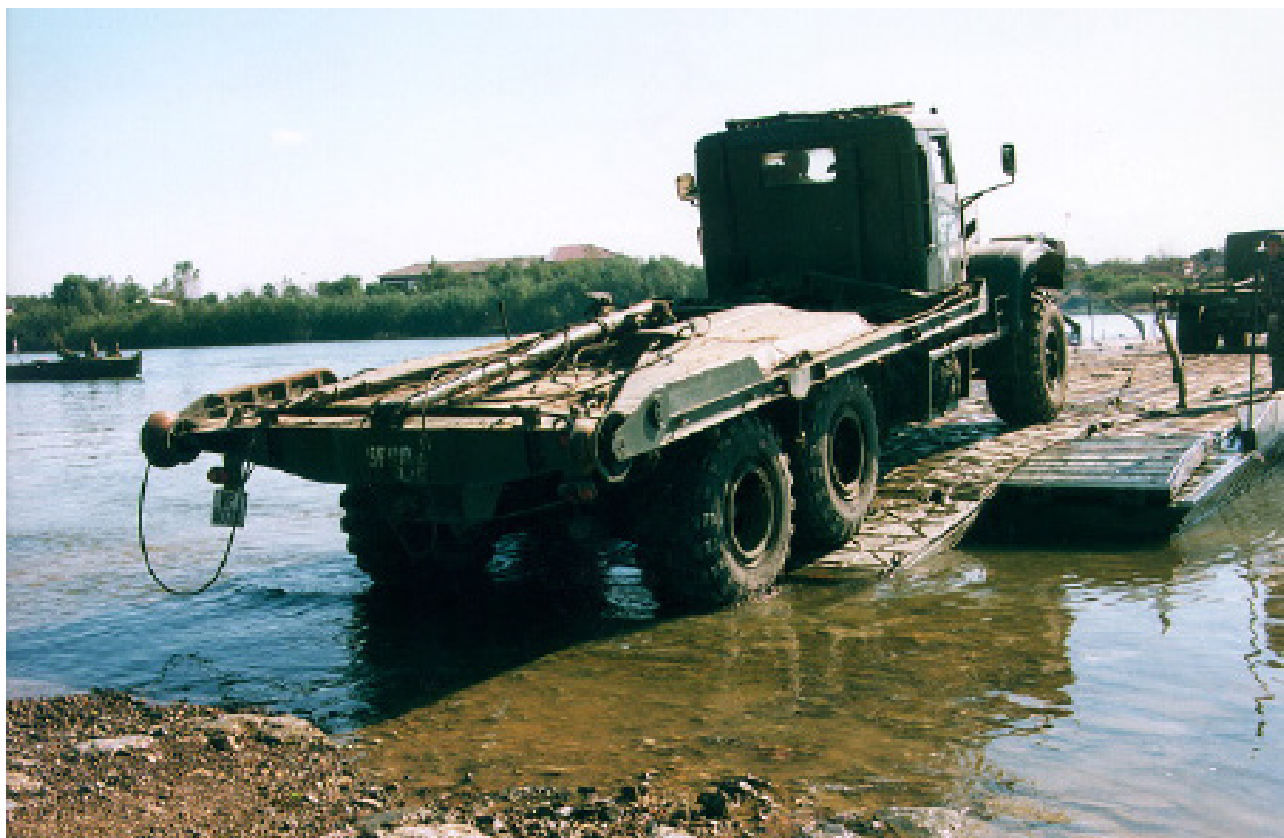
6. sz. kép: KRAZ-214 típusú ponton szállító tehergépkocsi Forrás: a szerző saját készítésű felvétele
