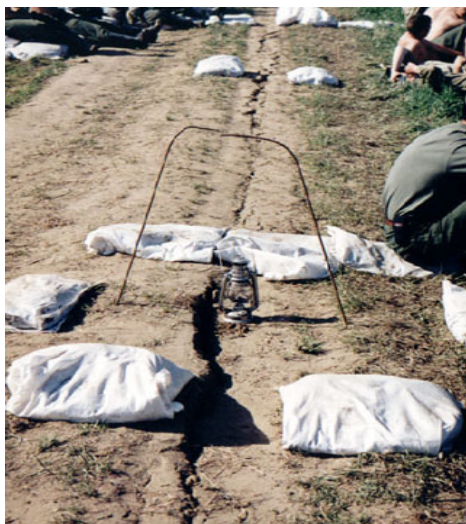
78. kép: Elmozdulás mérés a 2000. évi Kolopi-rámpa feletti suadásnál
