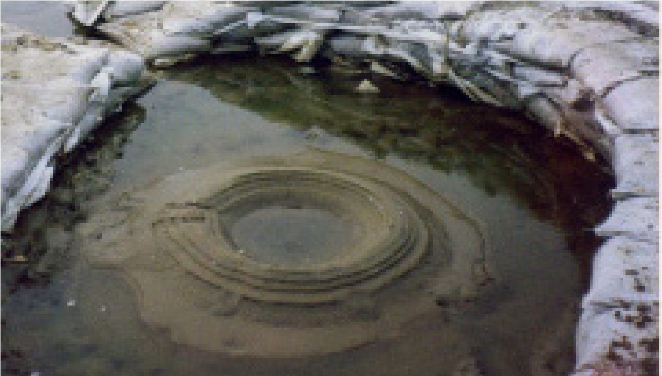
95. kép: Az 1998. évi dombrádi buzgár körülzárása és a kimosott anyag kúpja a vízszint csökkenése után.
