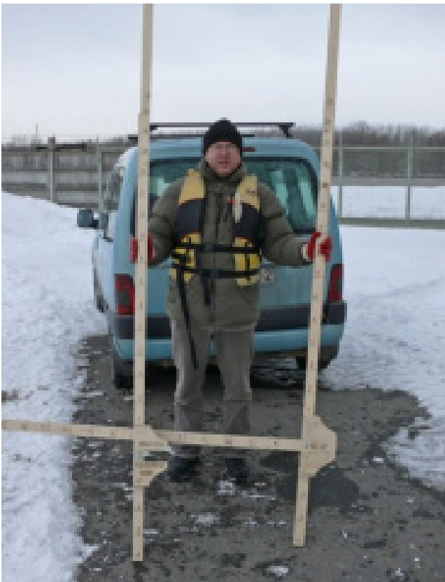
8. ábra: Keve-féle jégmérő léccsukva és nyitva (fotó: Farkas Z.)
