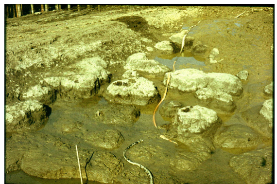
20. kép: Diszperzív talajrögök a Kettős-Körös 1980. évi gátszakadásánál, a gát alapjában
