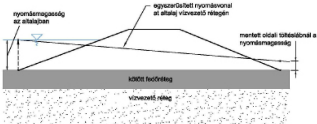
27. ábra: Az altalaj vízvezető rétegében kialakuló egyszerűsített nyomásvonal
