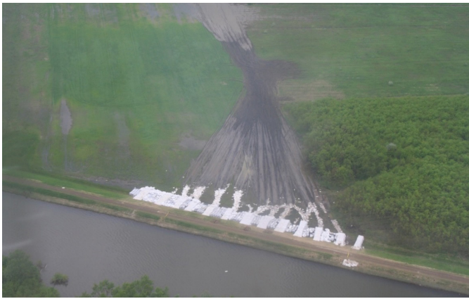
76. kép: Ballonok az Istvánházi suvadás bordái között, rendezett védekezés
