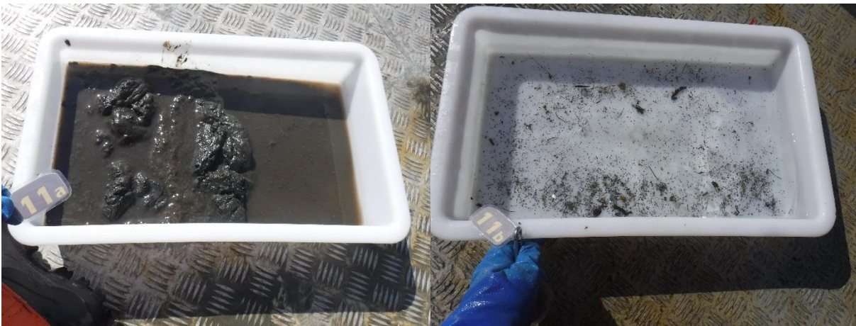
Figur 17: Bilder som viser sedimentet fra stasjon 11 før og etter siling. Sedimentet besto av silt og sand. Foto: Aqua Kompetanse AS. Det ble registrert fekalier i denne prøven.
