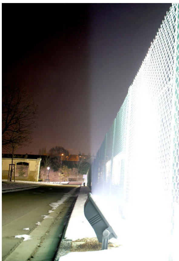
Image 26 Halo généré autour d'un projecteur. Photographie du halo généré autour d'un projecteur. Même avec une atmosphère relativement sèche, un temps d'obturation de 30 secondes laisse le halo imprimer la surface photosensible. © Samuel Challéat, ThéMA, 2010.
