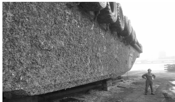
Abb. 4: Typischer Schiffsbewuchs, vorwiegend Seepocken ex: Micanti
