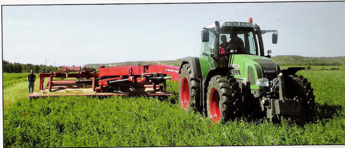
Figura 9. Segadora-acondicionadora de discos con el cabezal de siega dispuesto a la derecha de la lanza.
