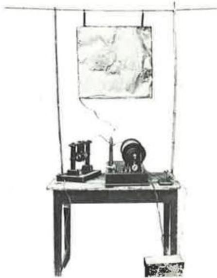
Figura 2.12 Réplica del primer aparato transmisor de Marconi, con una antena de cobre. Utilizó este tipo de transmisor en Italia, 1895, y en Salisbury Plain, Inglaterra, al año siguiente. Fuente: Michaelis, Anthony R., 1965. *Del semáforo al satélite*. Ginebra: Unión Internacional de Telecomunicaciones.
