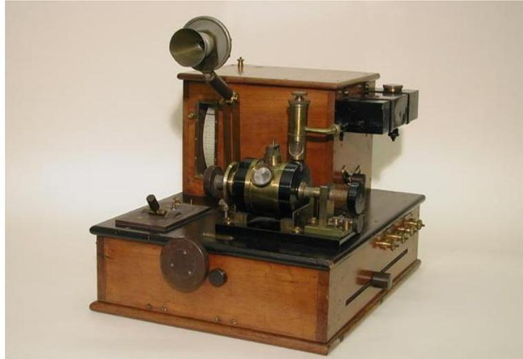
Figura 4.12 Transmisor radiotelefónico de Lorenz basado en el arco de poulsen. Fuente: Klawitter, Gerd, 2002. *100 años de la tecnología inalámbrica en Alemania*, vol. 2, Berlín: Ciencia y Tecnología
