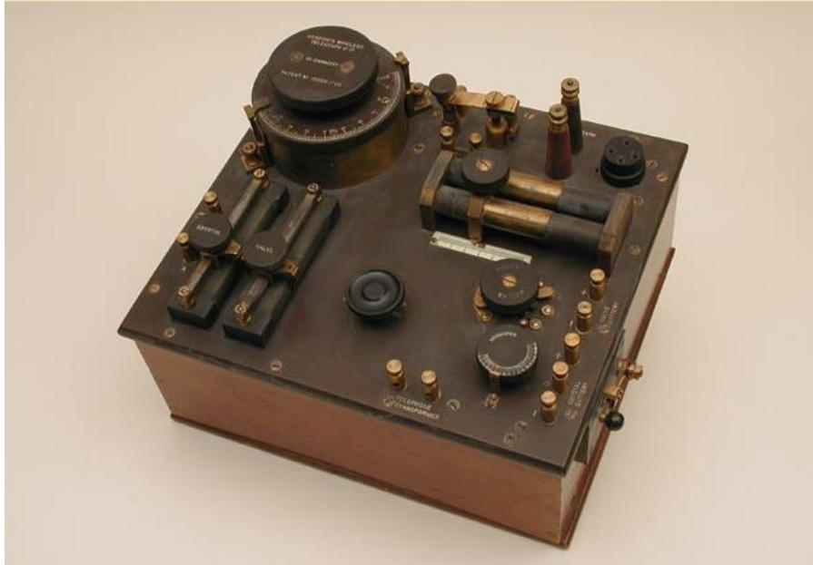
Figura 7.16 Receptor de válvulas y de cristal modelo 16. Podía detectar longitudes de onda entre los 250 y 3500 metros, 1916
