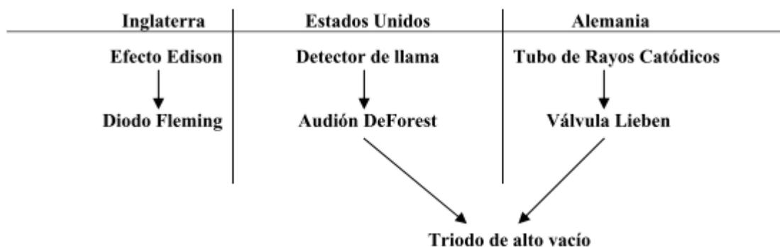
Figura 4.17 Recorrido esquemático de la invención y desarrollo del tríodo. Fuente: Gambau, Jose Carlos, 2008. "Historia de la invención del tríodo". *Recordando la Historia*. Foro Historico de las Telecomunicaciones
