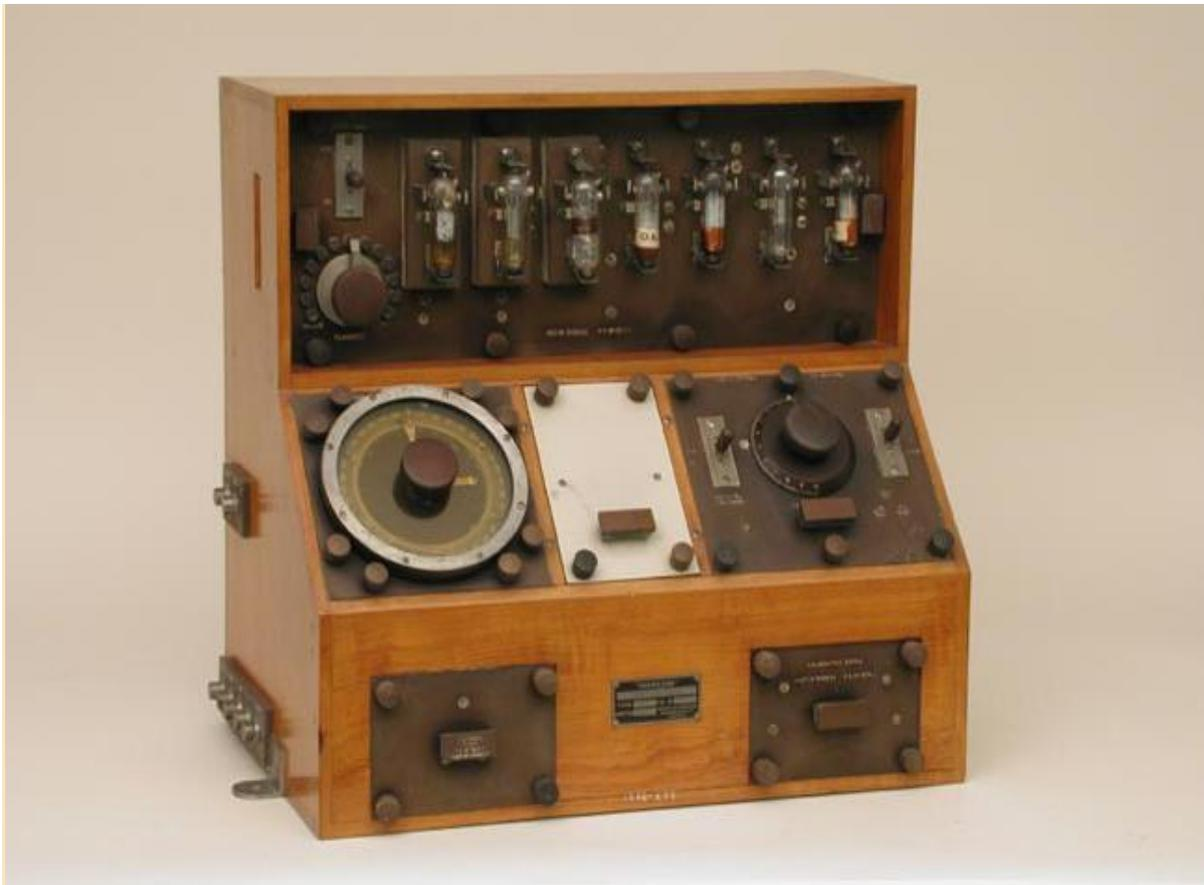
Figura 7.15 Direction-Finder tipo 11F. Estaba formado por siete válvulas y el panel de radiogoniometría, 1920.
