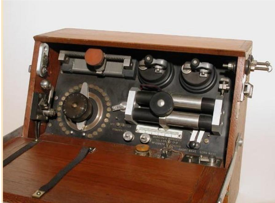
Figura 7.13 Receptor diseñado para ser utilizado en aeronaves. Tenía la capacidad de recibir dos rangos de longitud de onda, de onda corta y onda larga, de 90 y 700 metros. 1920
