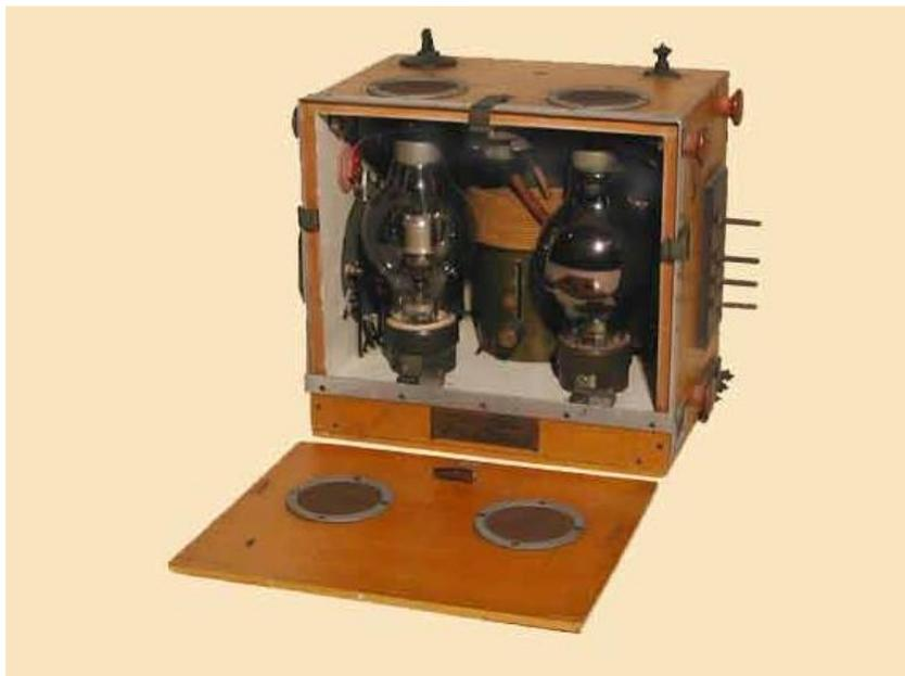
Figura 7.12 Transmisor de radiotelefonía. Poseía un selector automático de transmisión/recepción. 1919
