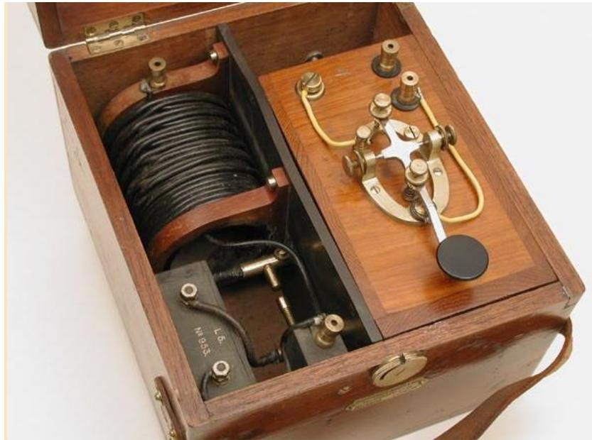
Figura 7.11 Transmisor de chispa portable para aeronaves. Contenía la parte del transmisor y la del generador del código Morse. 1912
