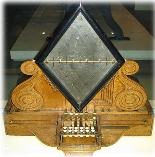
Figura 1.6 Telégrafo eléctrico de Wheatstone y Cooke. Fuente: <http://es.wikipedia.org/wiki/Telégrafo>
