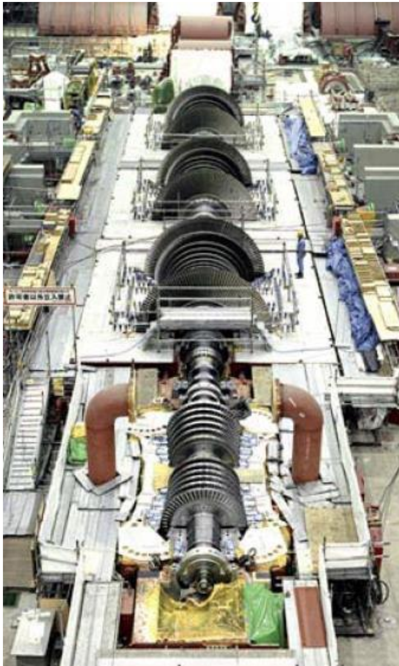
Figura 1.26. turbina de tres cuerpos: alta, media y baja presión
