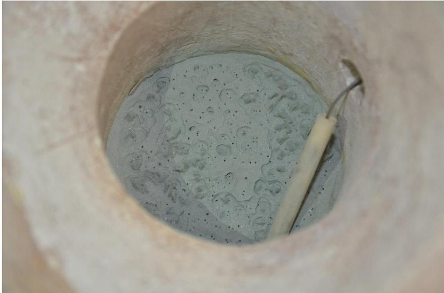
Figura 50. Canales de aire formados en la muestra durante el Ensayo 3.
