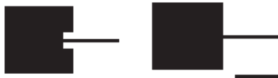
Fig. 3 Dibujos esquemáticos de stub conectado a un parche sin y con muesca
