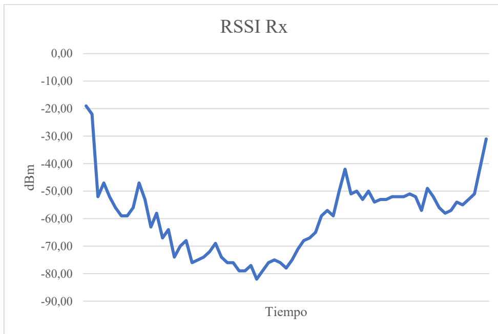
Ilustración 49. RSSI medida en el módulo receptor con la configuración 5 durante la primera prueba.
