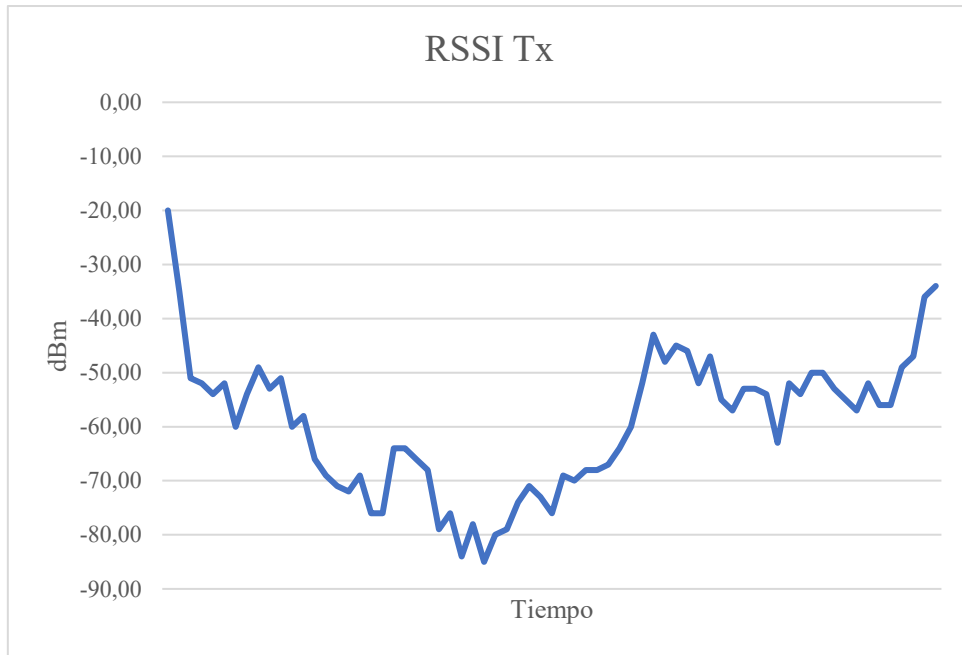
Ilustración 48. RSSI medida en el módulo transmisor con la configuración 5 durante la primera prueba.
