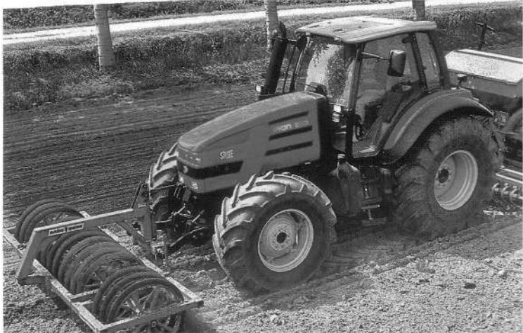
Existen tomas de fuerza traseras, frontales y laterales que permiten el accionamiento de diversos equipos y el uso de aperos combinados
