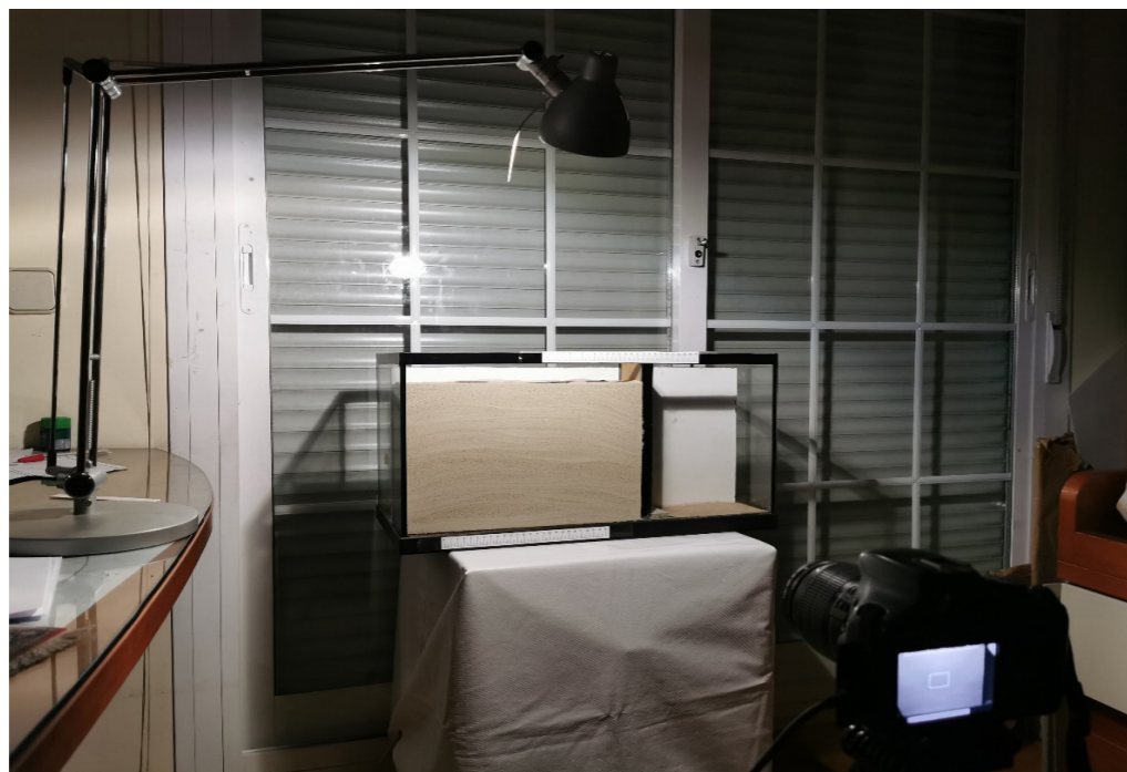
Imágen 11. Sist. completo DIC propio Elaboración propia
