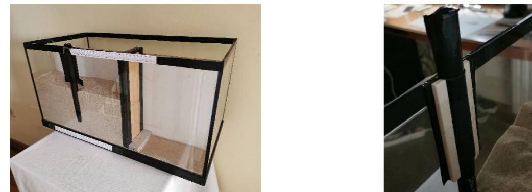
Imágenes 87. y 88. Modelo reducido pilote Elaboración propia
