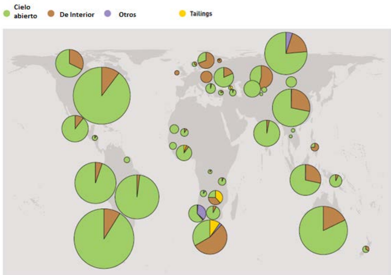
Figura nº 25 Producción de minerales en función del método de explotación (2011). (Fuente: ICMM, "Trends in the mining and metals industry," London2012)
