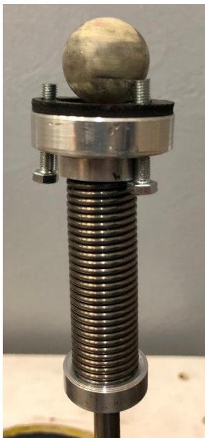
Figura 61. Rótula, anillo inferior, tornillos y junta de caucho. Imagen de perfil. Fuente: Elaboración propia.
