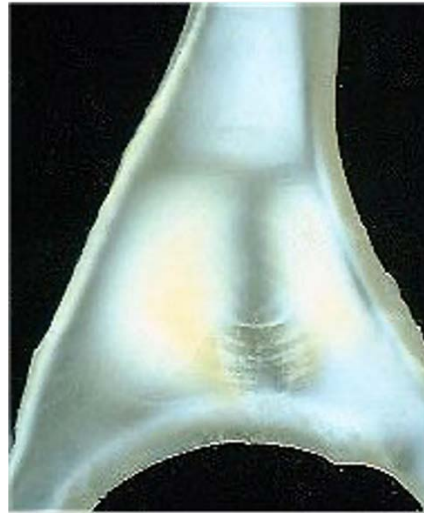
Figura 4.15: Tercera placa analizada mediante Fotoelasticidad con cotilo tipo CEDIOR Sulzer Medica. [Fuente: [11] Garrigosa, A.L]
