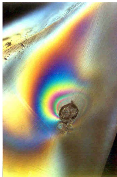
Figura 4.16: Concentración de tensiones en la parte posterior del acetábulo con cotilo tipo SECURFIT Stryker Howmedica Osteonics. [Fuente: [11] Garrigosa, A.L]
