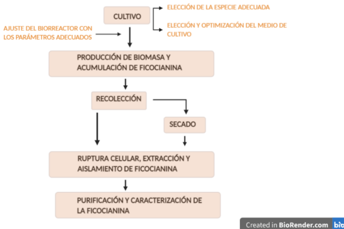
Figura 2. Esquema del proceso de producción, extracción y purificación de la C-Ficocianina 3 .
