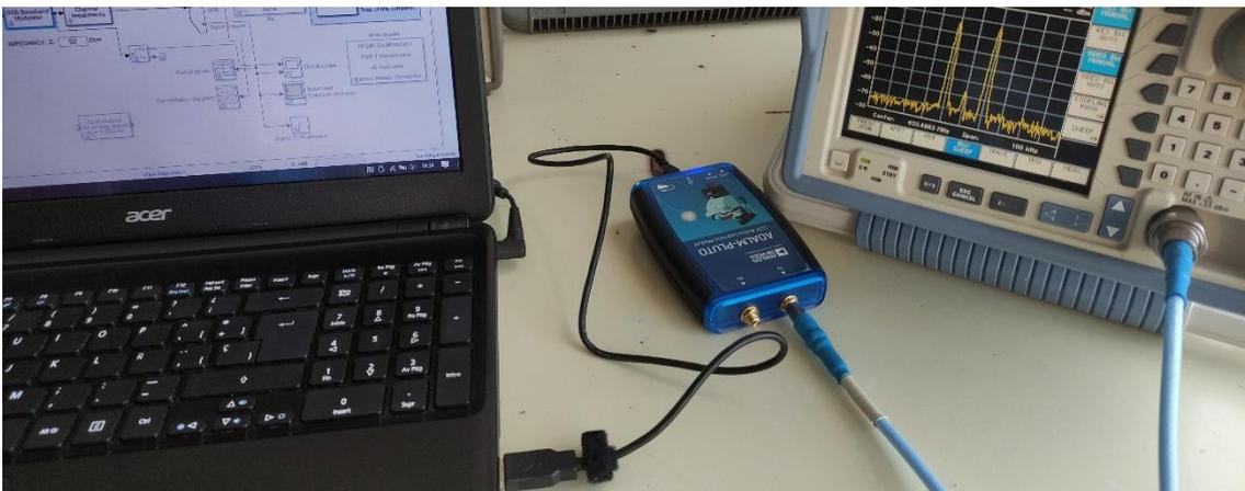
Figura 88. Montaje para ver la señal de salida en el analizador de espectros
