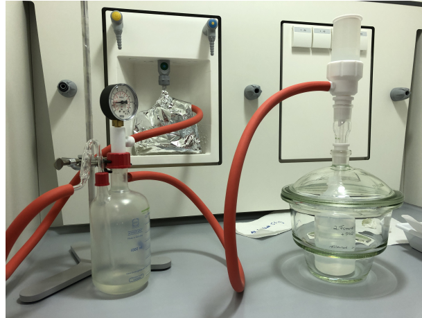
Abbildung 4.32: Das Foto zeigt den Aufbau für die Filtration der Lösungen, welche aus den Foraminiferen hergestellt wurden. Links im Bild ist eine Woulffsche Flasche. Rechts befindet sich ein Exsikkator, in welchem die Flasche für das Filtrat steht. Auf dem Exsikkator sitzt der Filter und ein Reservoir für die zu filtrierende Lösung.
