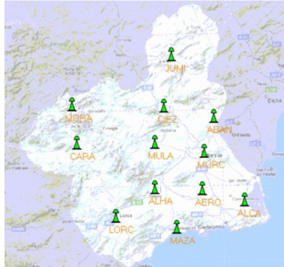
Fig. 3.6. Mapa de ubicaciones de la Red REGAM de estaciones permanente de la Región de Murcia
