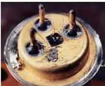
Foto del primer transistor MOS fabricado por **D. Khang**, **Mark M. Atalla**, y **E. Labate** a finales de 1959. Observaron que al aplicar una tensión pequeña a un metal que estaba encima de una capa de óxido que se había depositado sobre Silicio, se generaba una capa de inversión entre el óxido y el Silicio. Habían descubierto la “**Inducción de campo en la superficie de dispositivos Silicio-Dióxido de Silicio**”.
