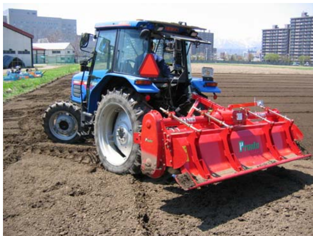
Fig. 6-19. Rotary Tiller (Breviglievi, PRONTO-260).
