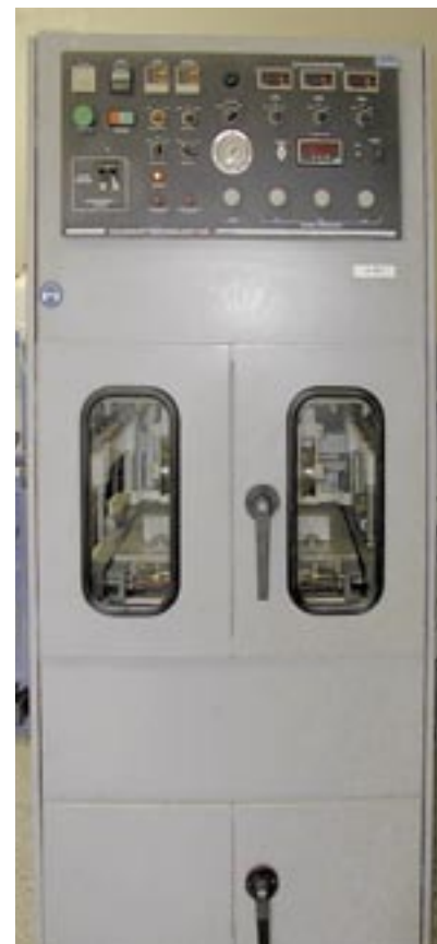
Pista a escala, de laboratorio que simula la deformación permanente de la mezcla.
