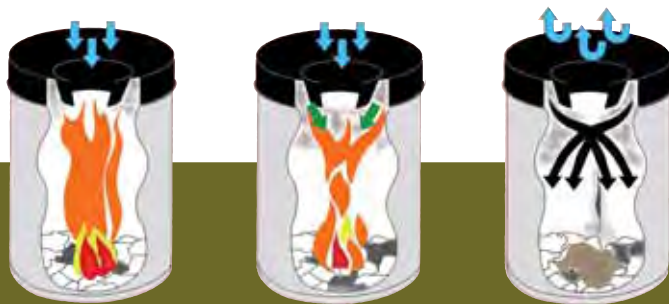
Funktionsweise des flammhemmendem Löschkopfs functionality of flame-retardant top
