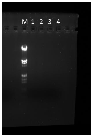
Εικόνα 3.2.6: Ηλεκτροφόρηση πήγματος αγαρόζης των δειγμάτων για την ανίχνευση του γονιδίου agg . M: μάρτυρας λDNA- Hind III (μέγεθος από πάνω προς κάτω σε bp: 21226, 5148, 4973, 4268, 3530, 2027, 1904, 1584, 1375, 947, 831, 534), 1: προϊόν της αντίδρασης για το στέλεχος L. suionicum am SF03, 2: προϊόν της αντίδρασης για το στέλεχος L. pentosus 208, 3:
