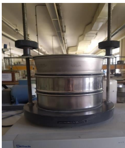
Εικόνα 6.1: Εργαστηριακά κόσκινα των 500 και 250 \mu\text{m} που χρησιμοποιήθηκαν για την κατανομή μεγέθους σωματιδίων των δειγμάτων ιλύος που αναλύθηκαν.
