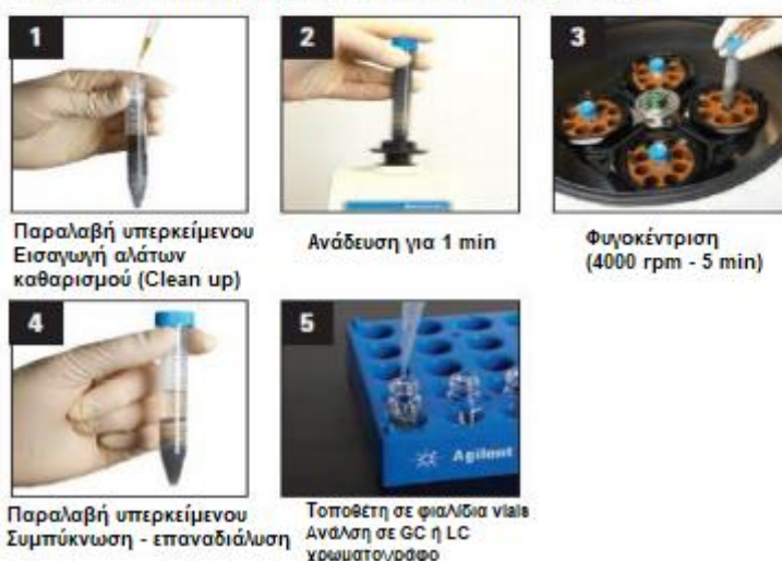
Σχήμα 4.6: Βήματα της μεθόδου εκχύλισης QuEChERS (πηγή: Agilent Technologies Inc.)
