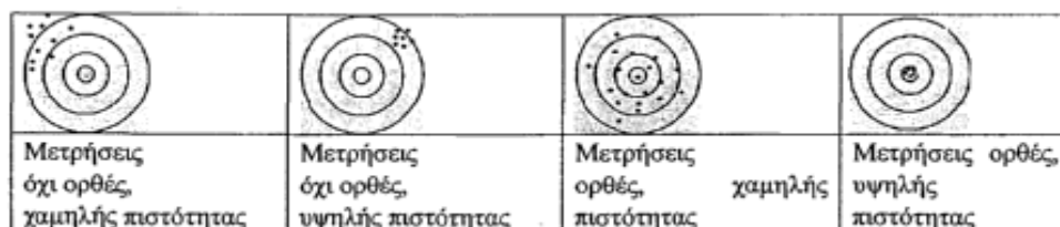
Σχήμα 3.4 Διαφοροποίηση των εννοιών ορθότητας και πιστότητας κατά τις πειραματικές μετρήσεις (Κωνσταντίνου Ι., 2005).
