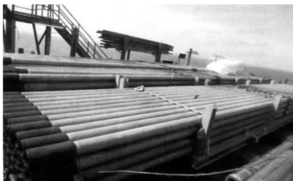
16. ábra: Második generációs alumínium-ötvözetű fúrócsövek a HZ 19-2 tengeri fúrófedélzeten
