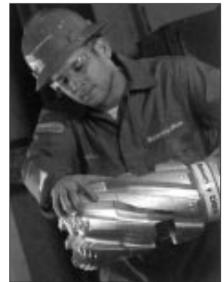
25b) ábra: Speciális PDC-fúró, Halliburton Security DBS, FM 3000
