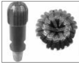
16b) ábra: Karbonátos kőzetek fúrására alkalmas gyémántfűrő IADC D813
