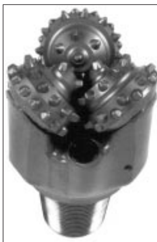
13a) ábra: Karbonátos kőzetek fúrására alkalmas görgős fúró IADC 437
