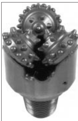
13b) ábra: Karbonátos kőzetek fúrására alkalmas görgős fúró IADC 447
