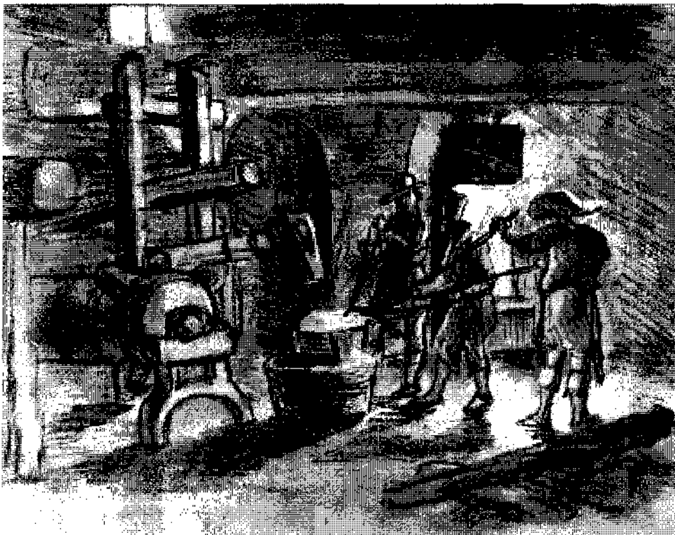
Abb. 12: Arbeit am Aufwerfhammer des Frischwerkes der Eisenhütte Erla, um 1830, Zeichnung von Theodor von OER, Museum Schloß Schwarzenberg
