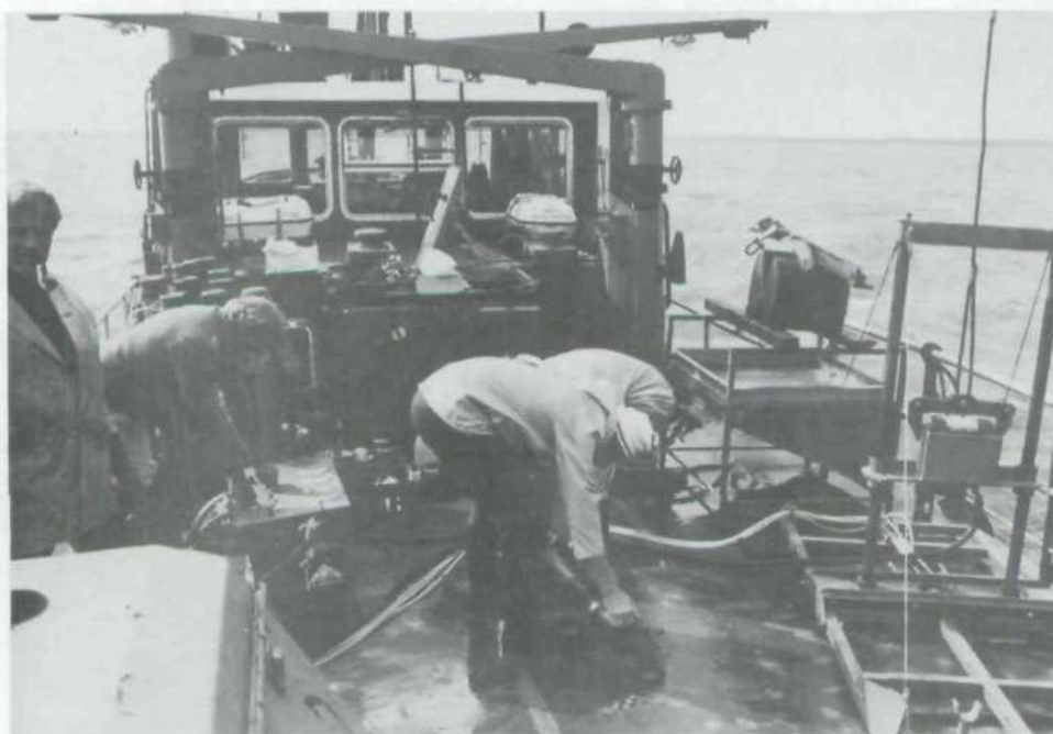
Foto 2. Arbeidsterrein aan boord van een van de vaartuigen van de Adviesdienst Hoorn. Van rechts naar links: de Zenkovitch; de Van Veen-happer op een sorteer/zeefbak; het verwijderen van de boorkern met omhullende plastic buis uit de steekbuis; schakelpaneel pneumatiek; compressor. Foto RIJP.
