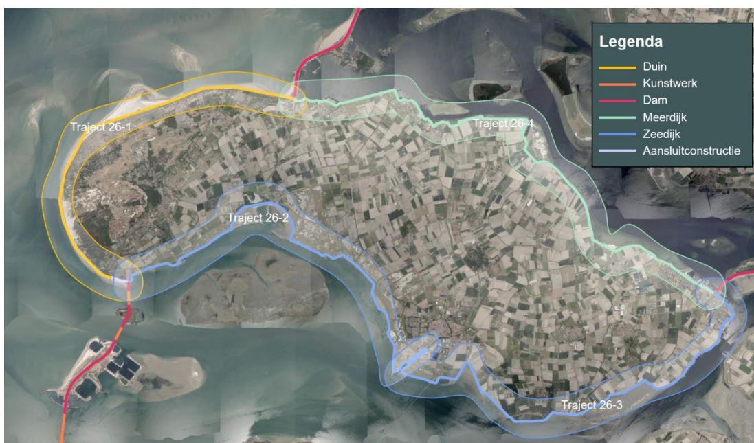
Figuur 4-8. Overzicht waterkeringen dijkkring 26 (gebaseerd op Pers. Comm. Waterschap Scheldestromen, 2017).
