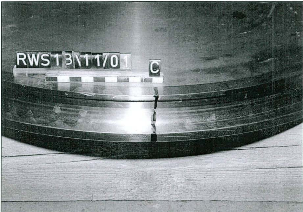
Abb. 4.6: Deckelunterseite und Deckelbund (Stelle C) nach den Kippversuchen am ungeschmierten Topflager
