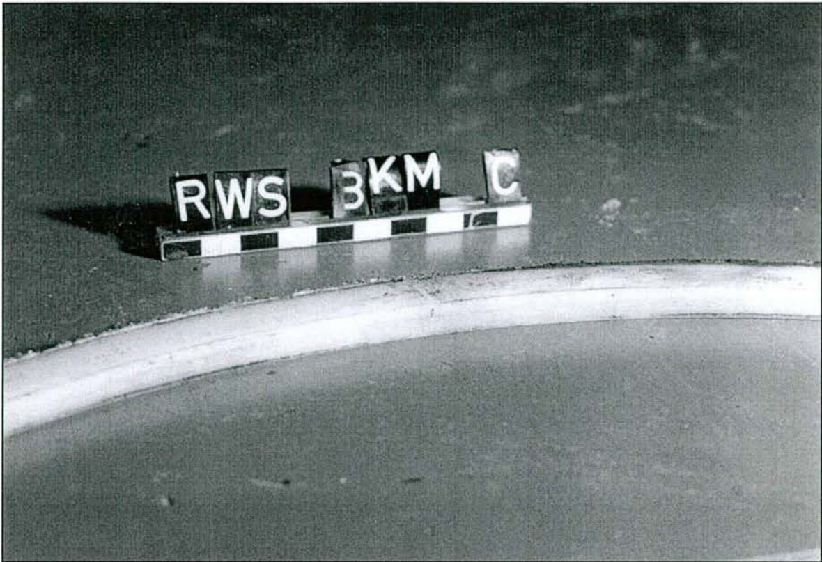
Abb. 9.26: UHMWPE-Innendichtung mit geringer Wulstbildung bei C (in Kipprichtung)
