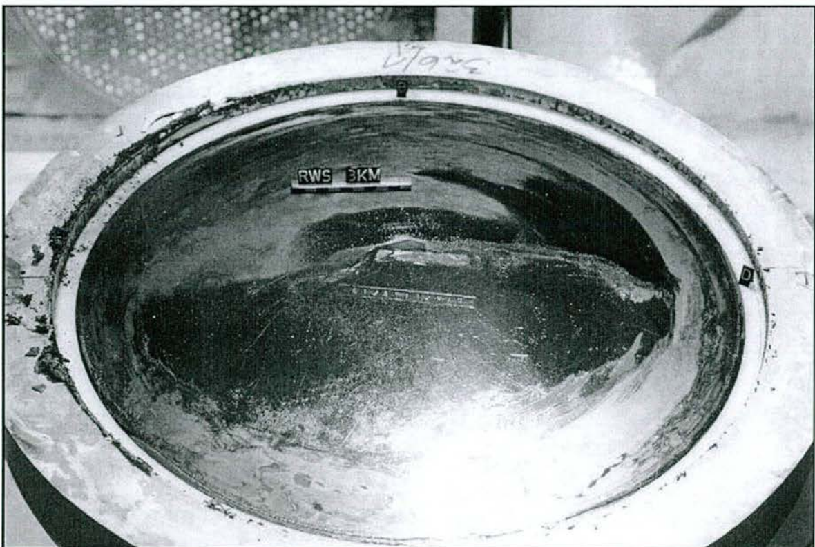
Abb. 9.2: Topf mit Elastomerkissen und Innendichtung nach Durchführung der Zusatzversuche (3000 m-Verschleißtest und Kurzzeit-Kippversuche)
