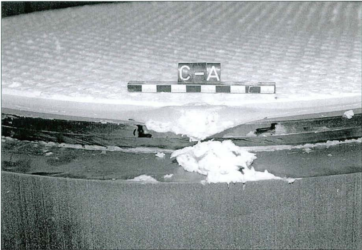
Abb. 6.14: Erster Defekt am UHMWPE-Verstärkungsring des Gleitlagers im Bereich A-C (Übersicht)
