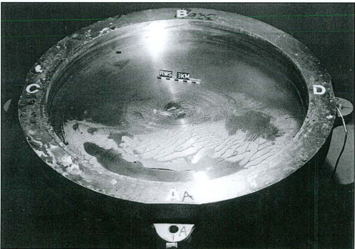
Abb. 9.14: Lagertopf nach Ausbau der UHMWPE-Innendichtung und des Elastomerkissens
