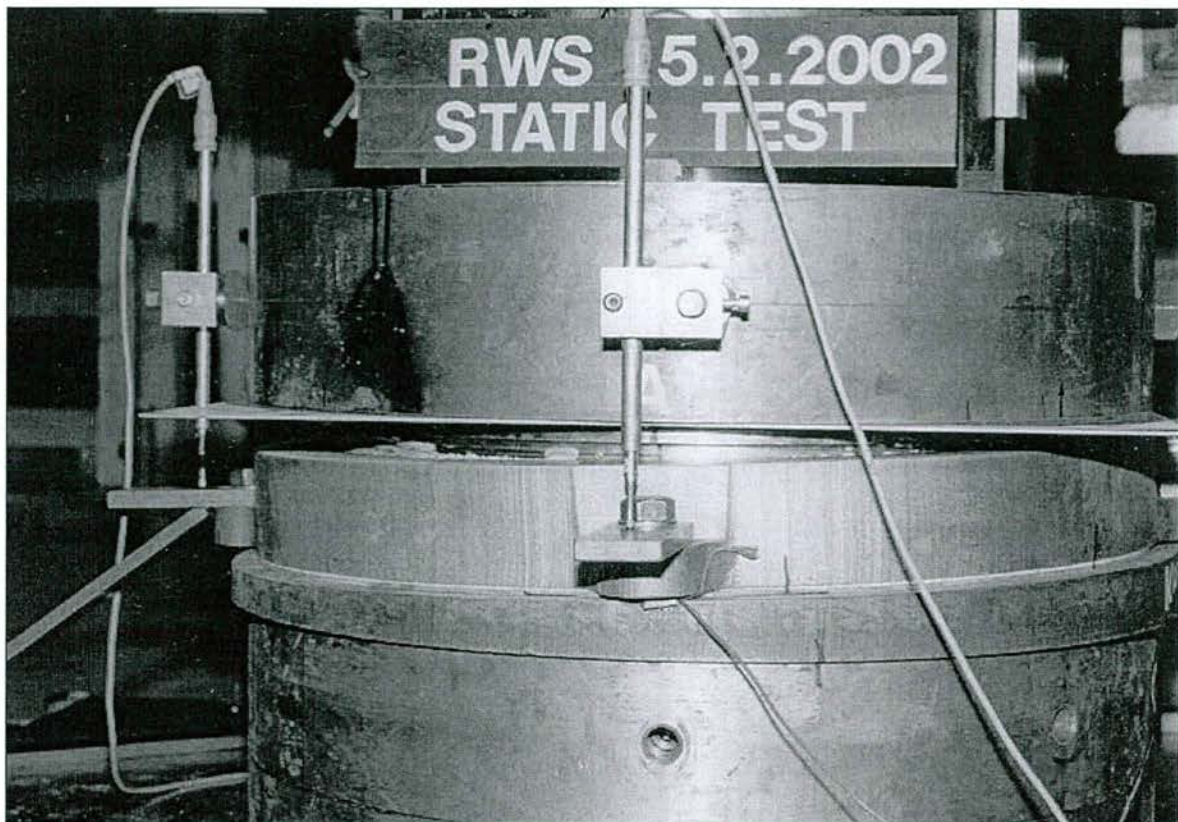
Abb. 6.6: Versuchslager nach Aufbringen der Vertikallast von 15 MN
