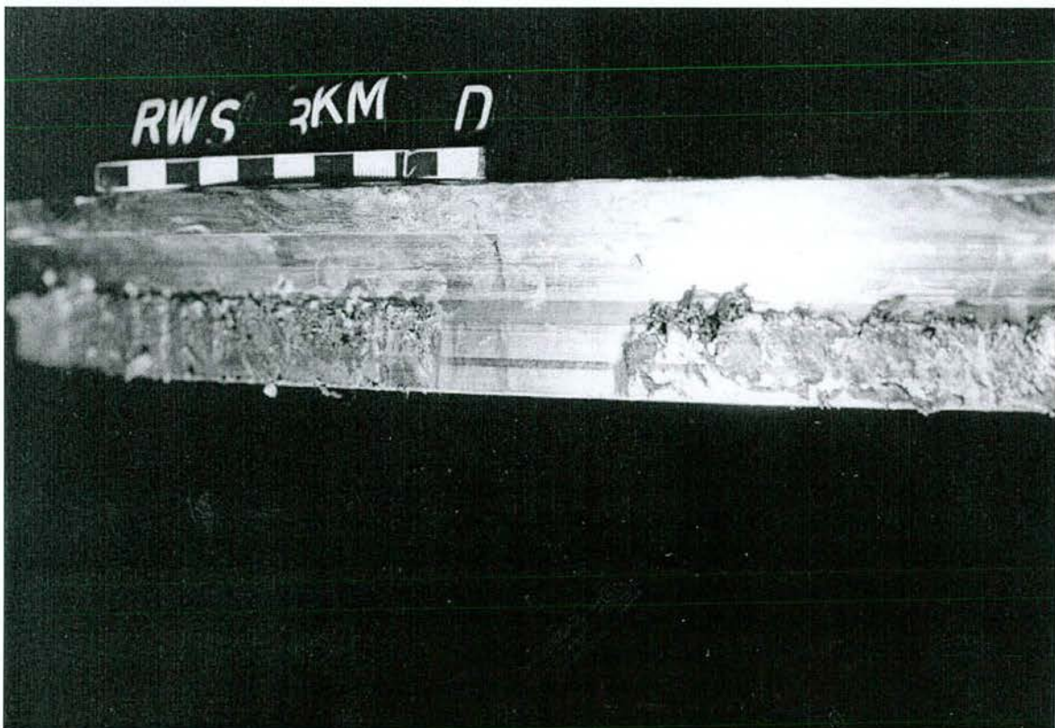
Abb. 9.6: Deckelbund an der Stelle D (in Kipprichtung) nach örtlichem Säubern mit einem Lappen
