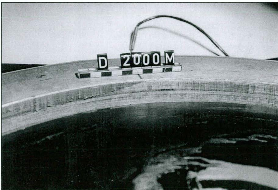
Abb. 5.17: Topfwand bei Stelle D (in Kipprichtung) nach Ausbau der UHMWPE-Innendichtung nach dem 2000 m-Verschleißversuch
