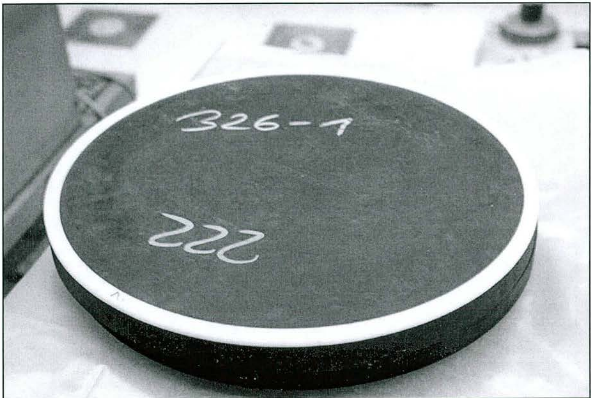
Abb. 2.1: NYH-Elastomerkissen mit UHMWPE-Innendichtung
