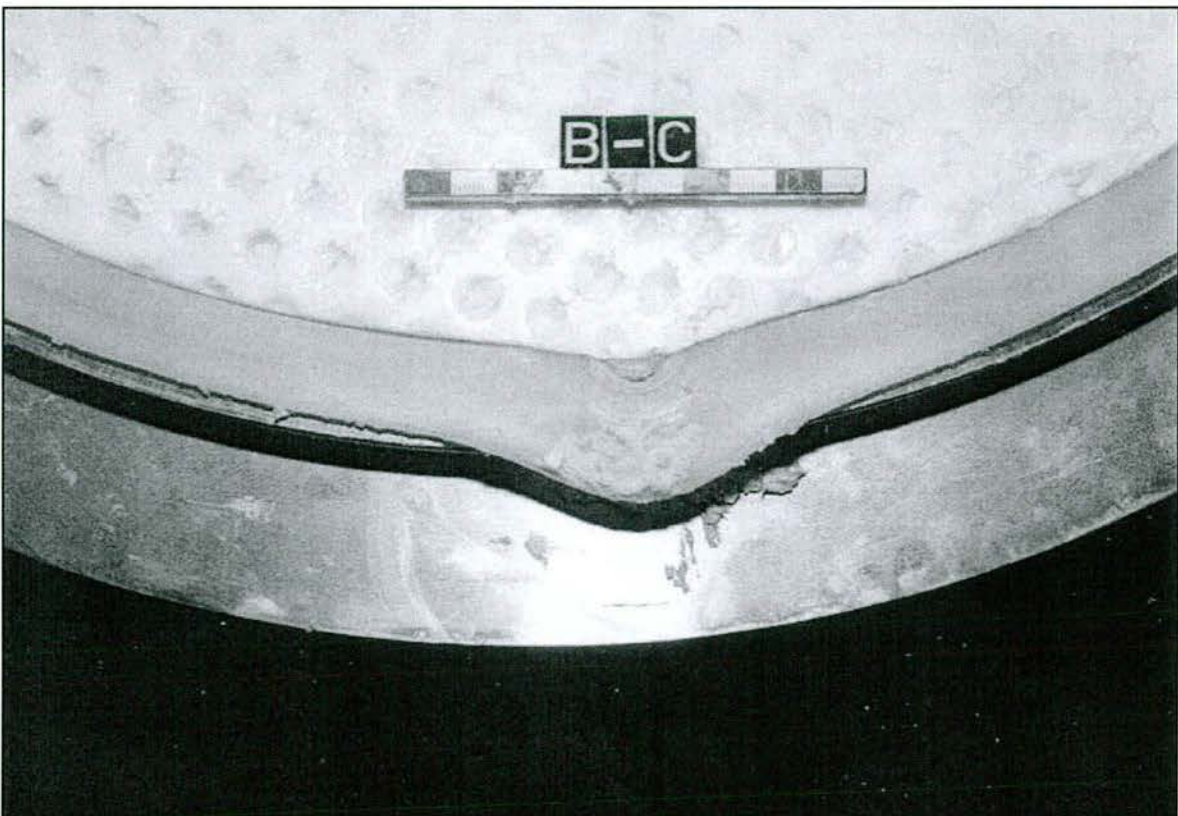
Abb. 6.17: Zweiter Defekt am UHMWPE-Verstärkungsring des Gleitlagers im Bereich B-C (Detailaufnahme)
