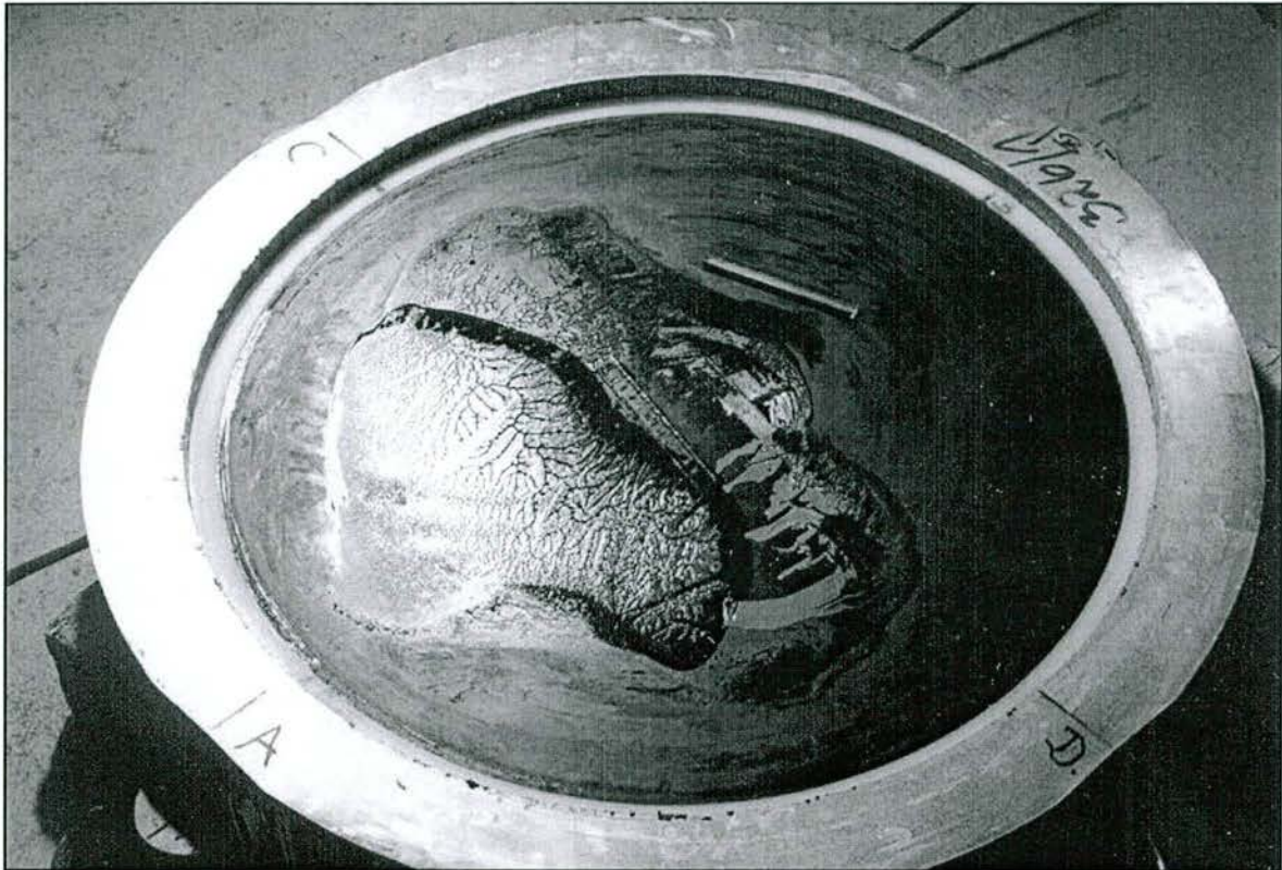
Abb. 5.9: Geöffnetes Topflager nach dem 2000 m-Verschleißversuch (Kippachse A-B)
