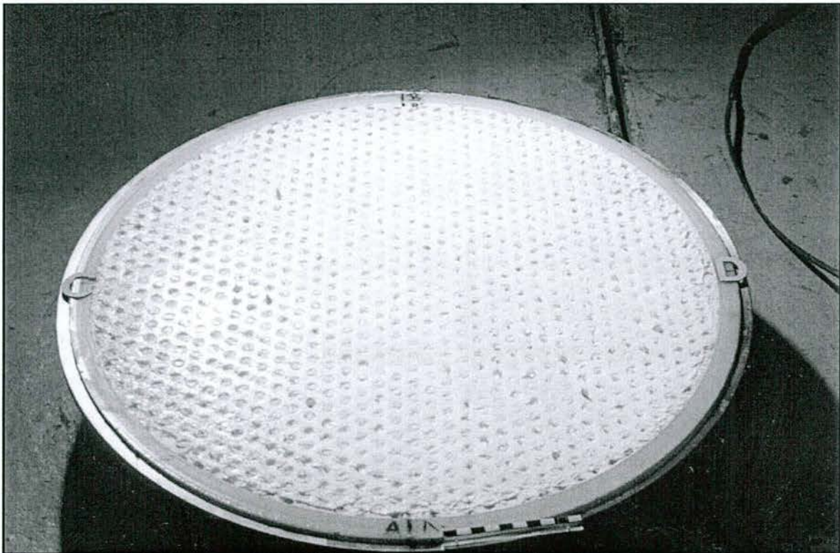
Abb. 5.7: PTFE-Platte und UHMWPE-Verstärkungsring des Gleitteils nach dem 2000 m-Verschleißversuch
