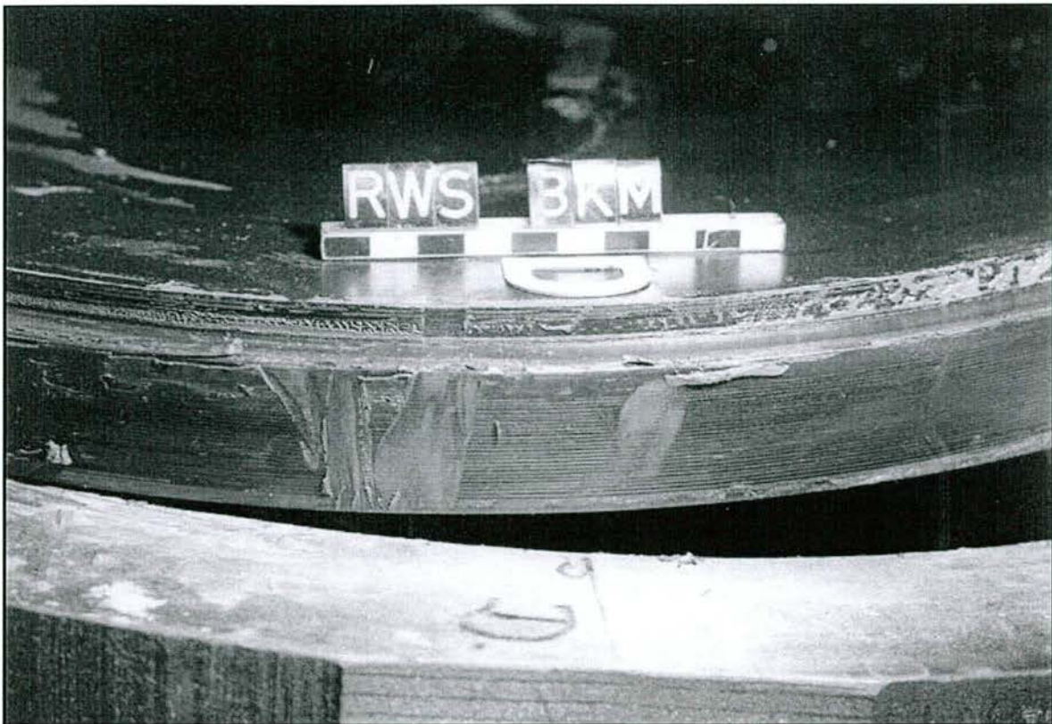
Abb. 9.22: Elastomerkissen nach Ausbau aus dem Topf: Detailaufnahme des Rondenrands bei D (in Kipprichtung)
