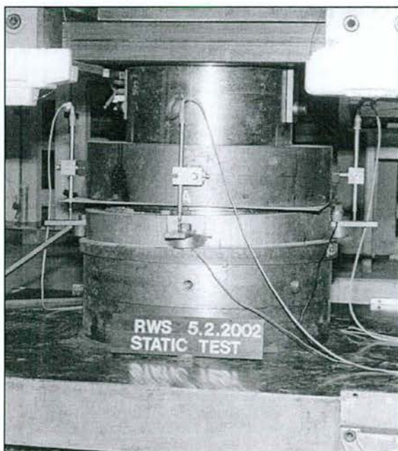
Abb. 6.2: Versuchsaufbau für den statischen Langzeit-Belastungsversuch (Foto links: Ansicht von vorne (Stelle A); Foto rechts: Seitenansicht (Stelle D))
