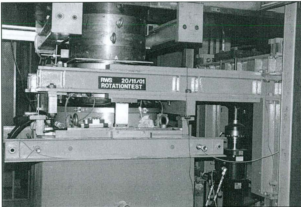
Abb. 3.2: Kippversuchsstand mit eingebautem Topflager
