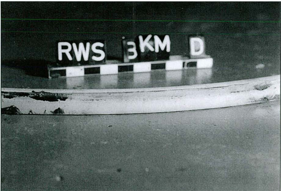
Abb. 9.29: UHMWPE-Innendichtung mit starker Wulstbildung bei D (in Kipprichtung)
