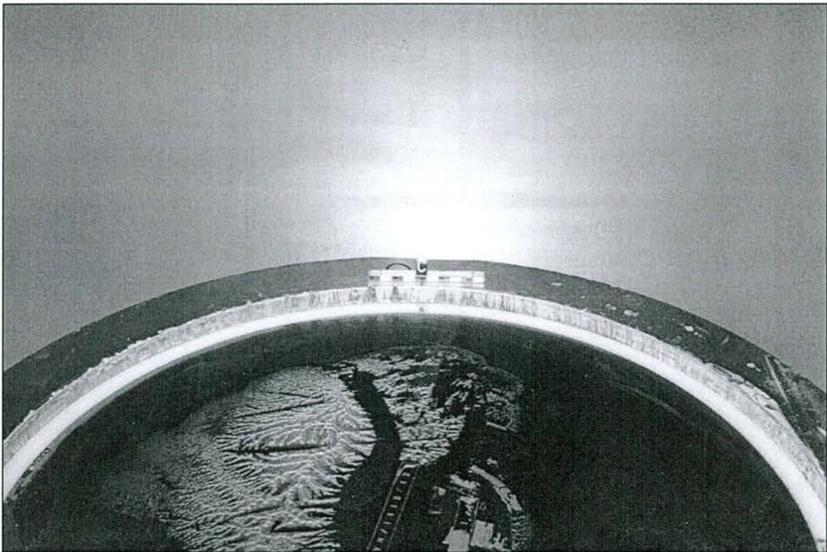
Abb. 5.11: Topf mit Elastomerkissen und UHMWPE-Innendichtung nach dem 2000 m-Verschleißversuch (Stelle C, in Kipprichtung)
