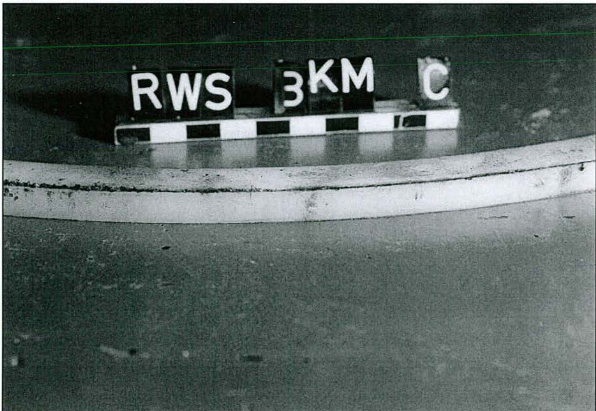
Abb. 9.27: UHMWPE-Innendichtung mit geringer Wulstbildung bei C (in Kipprichtung)
