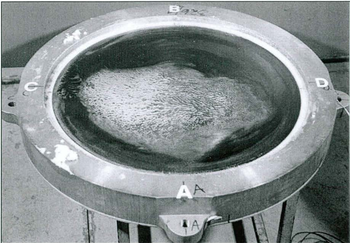
Abb. 6.18: Geöffnetes Topflager nach dem statischen Langzeit-Belastungsversuch
