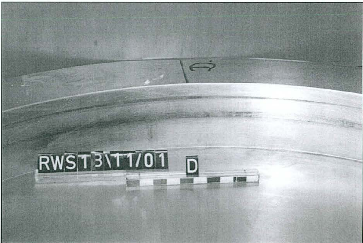
Abb. 4.10: Topwandinnenseite nach den Kippversuchen am ungeschmierten Topflager (Stelle D)
