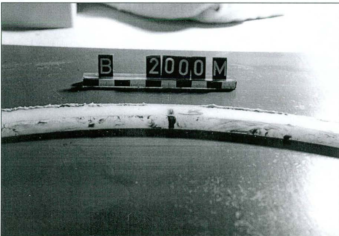
Abb. 5.19: UHMWPE-Innendichtung nach dem 2000m-Verschleißversuch (Stelle B, in der Kippachse)
