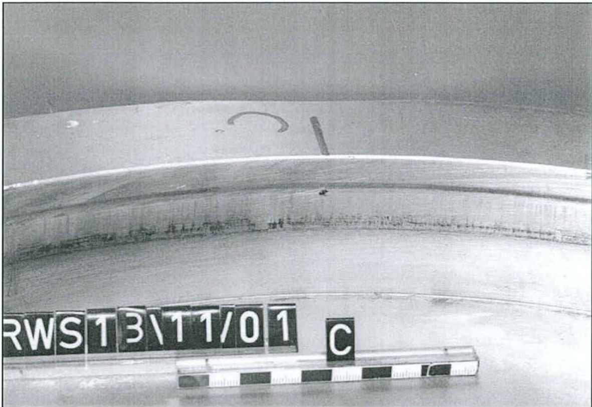
Abb. 4.9: Topwandinnenseite nach den Kippversuchen am ungeschmierten Topflager (Stelle C)
