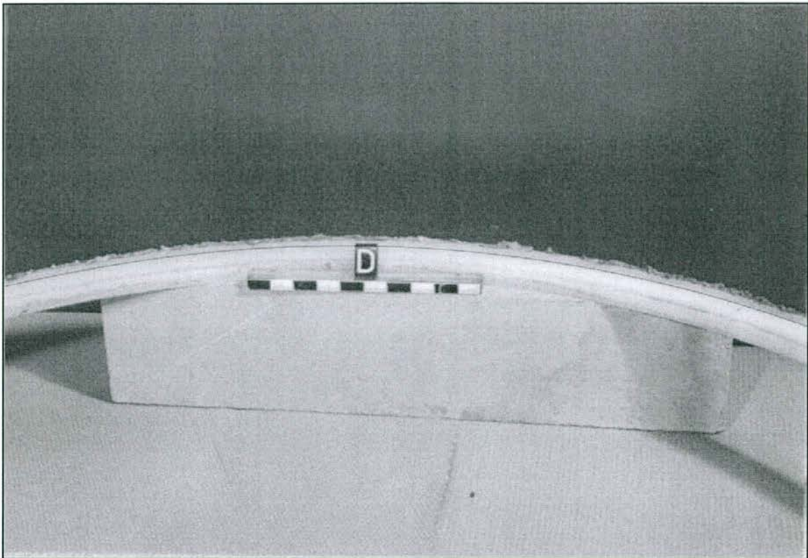
Abb. 6.25: UHMWPE-Innendichtung nach dem Langzeit-Belastungsversuch: Detailaufnahme bei Stelle D (mit gesamtem Lagerspiel, Wulstkontur nachgezeichnet)
