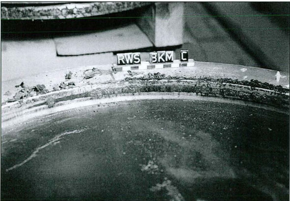
Abb. 9.10: Topf mit Elastomerkissen an der Stelle C (in Kipprichtung) nach Ausbau der UHMWPE-Innendichtung
