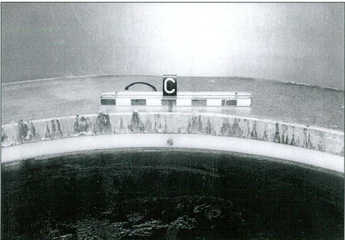
Abb. 5.12: Topf mit Elastomerkissen und UHMWPE-Innendichtung nach dem 2000 m-Verschleißversuch (Stelle C, in Kipprichtung)
