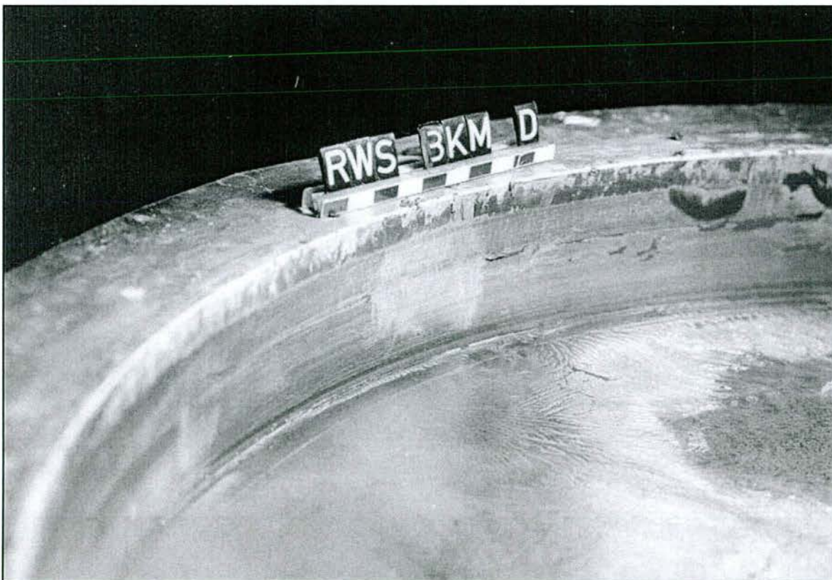
Abb. 9.18: Lagertopf nach Ausbau des Elastomerkissens: Kontaktfläche der UHMWPE-Innendichtung bei D (in Kipprichtung)
