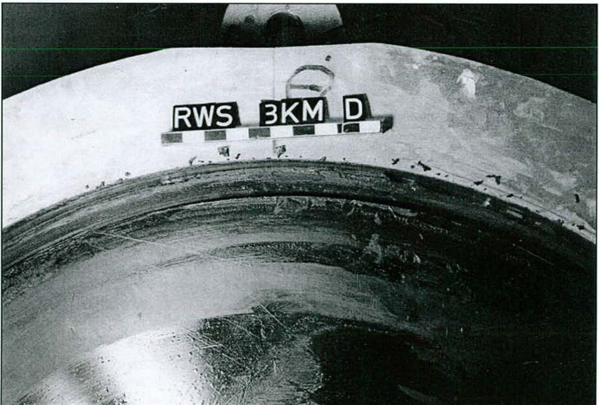
Abb. 9.12: Topf mit Elastomerkissen an der Stelle D (in Kipprichtung) nach Ausbau der UHMWPE-Innendichtung
