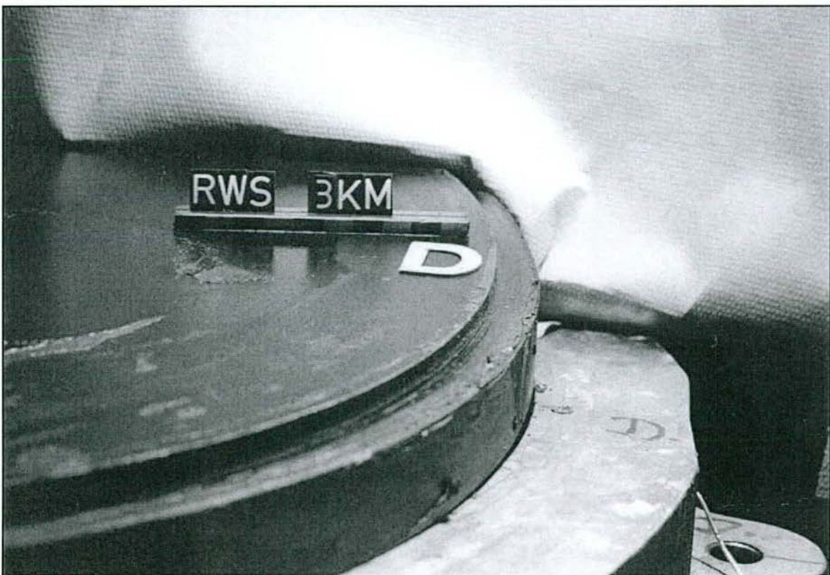
Abb. 9.23: Elastomerkissen nach Ausbau aus dem Topf: Detailaufnahme des Rondenrands bei D (in Kipprichtung)
