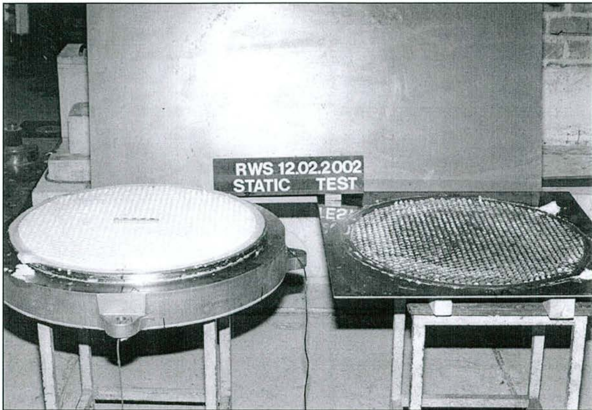
Abb. 6.12: Geöffnetes Gleitlager nach dem statischen Langzeit-Belastungsversuch
