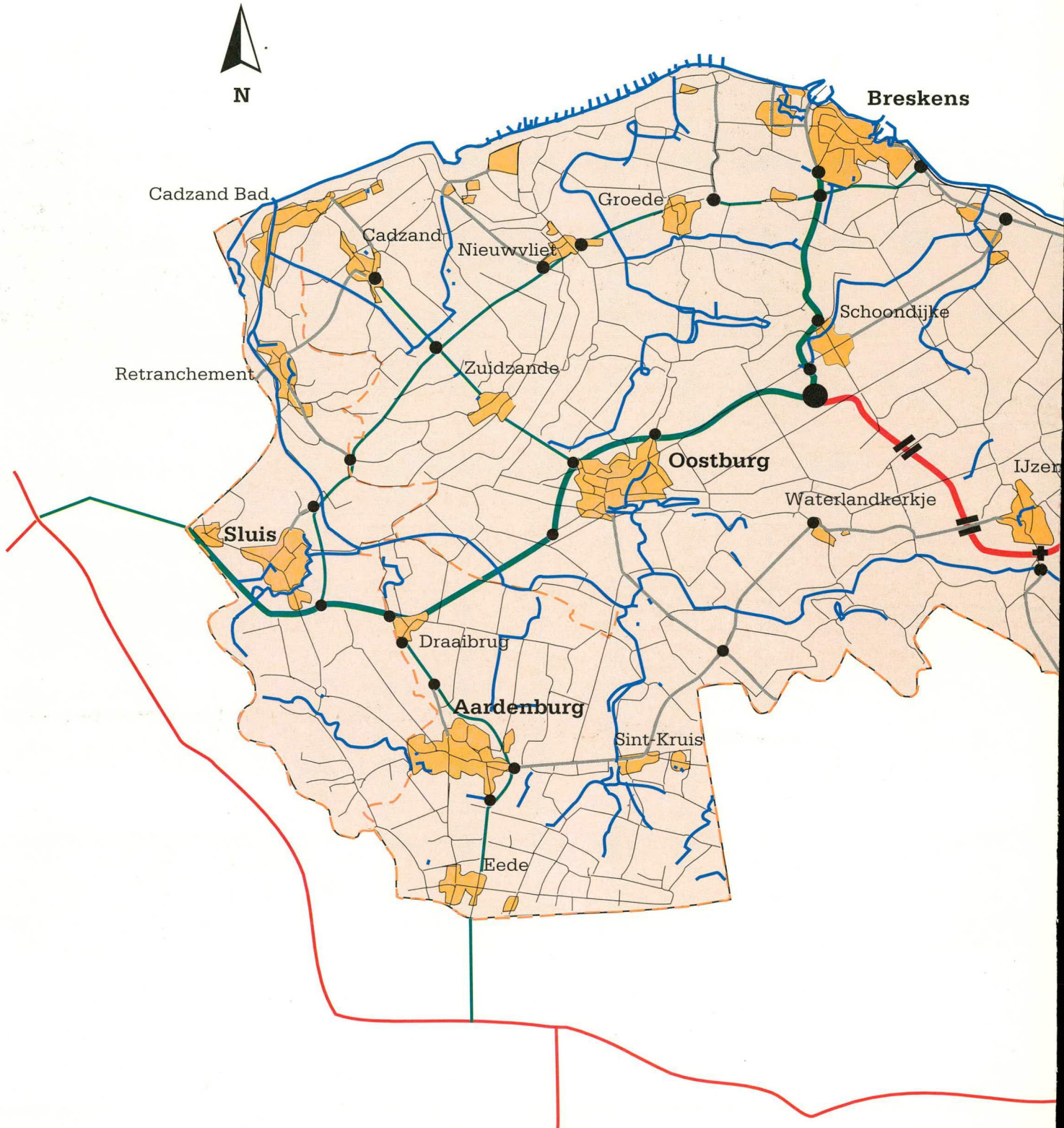
De duurzaam veilige categorie-indeling van het wegennet in West Zeeuwsch Vlaanderen volgens variant 2
