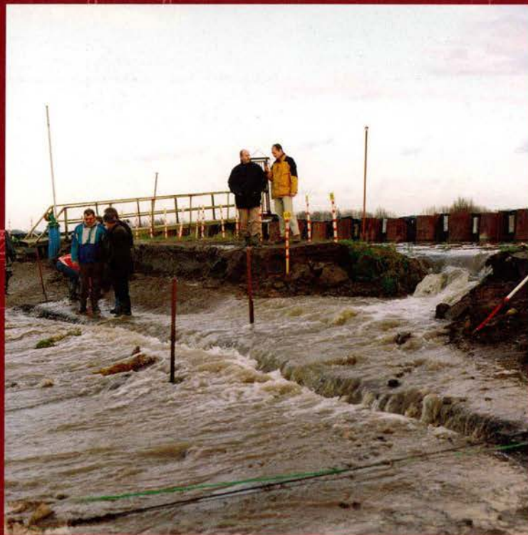
Bezweken onder te hoge waterstand? Nee, deze oude dijk bij Bergambacht werd kunstmatig tot instorten gebracht in een experimenteel onderzoek naar de sterkte van de dijken.
