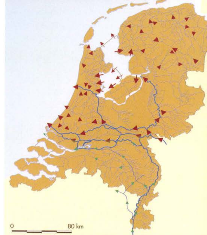
De verdeling van het Rijn- en Maaswater over heel Nederland. De belangrijkste 'kranen' in dit systeem zijn de stuw bij Driel en de Haringvlietsluizen. Het stuwcomplex bij Driel verdeelt het water van de Rijn over de IJssel, het IJsselmeer, de Nederrijn en de Lek. Via de Haringvlietsluizen kan het Maas- en Rijnwater naar de Nieuwe Waterweg gedirigeerd worden om de verzilting tegen te gaan. Via regionale en lokale waterstaatkundige werken bereikt het rivierwater ook de 'haarvaten' van het waterhuishoudkundige systeem.
