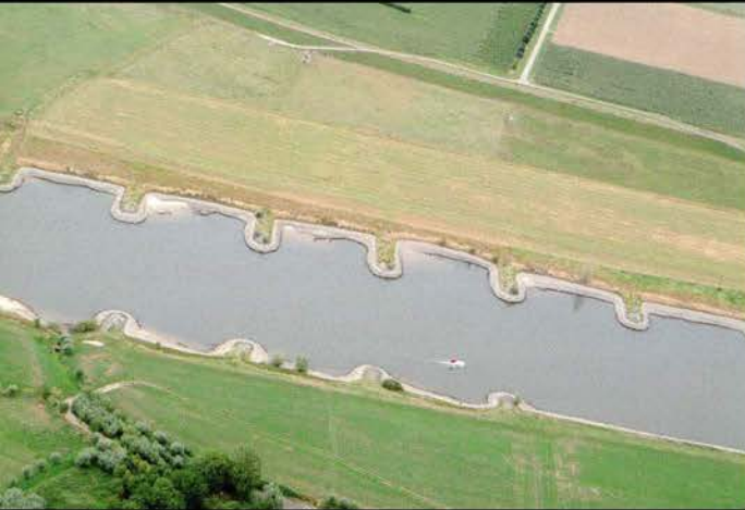
Van de Rijnakkers zijn de oevers van de IJssel het zwaarst 'genormaliseerd'. Zij zijn vrijwel geheel in steen gezet waardoor de IJssel geen kant meer op kan. Rivierprocessen als erosie en sedimentatie spelen hier nog nauwelijks een rol.
