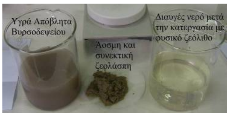
Σχήμα 5.7. Κατεργασία υγρών αποβλήτων βυρσοδεψείου με τη χρήση υψηλής ποιότητας φυσικού ζεολίθου (Filippidis 2008)
