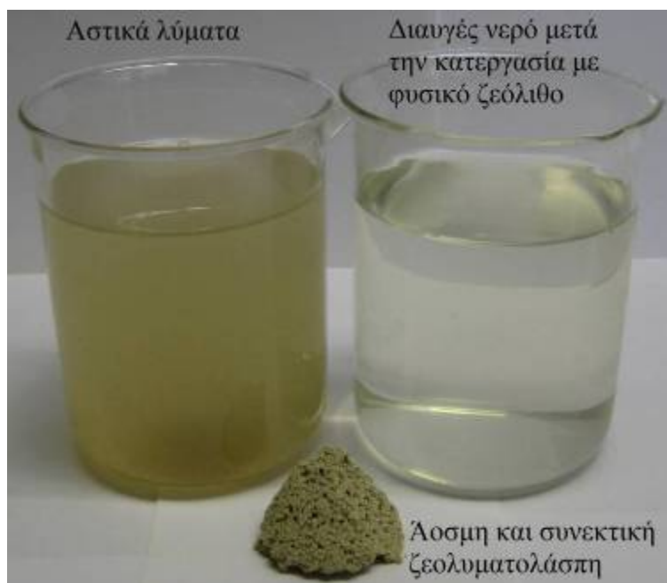
Σχήμα 5.5. Κατεργασία αστικών λυμάτων με τη χρήση υψηλής ποιότητας φυσικού ζεολίθου (Filippidis 2008)
