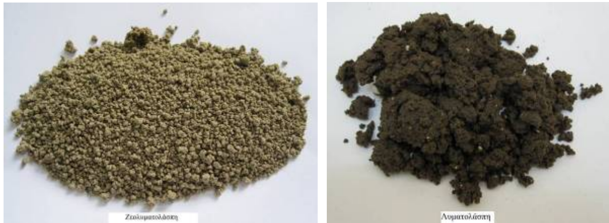
Σχήμα 5.11. Παραγωγή άοσμης και συνεκτικής ζεολυματολάσπης (αριστερά) με τη κατεργασία λυματολάσπης (δεξιά) με υψηλής ποιότητας φυσικό ζεόλιθο (Filippidis 2010).
