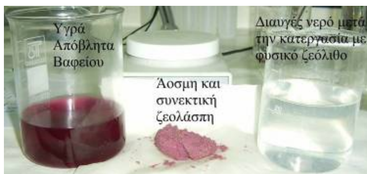
Σχήμα 5.6. Κατεργασία υγρών αποβλήτων βαφείου με τη χρήση υψηλής ποιότητας φυσικού ζεολίθου (Φιλιππίδης 2007).
