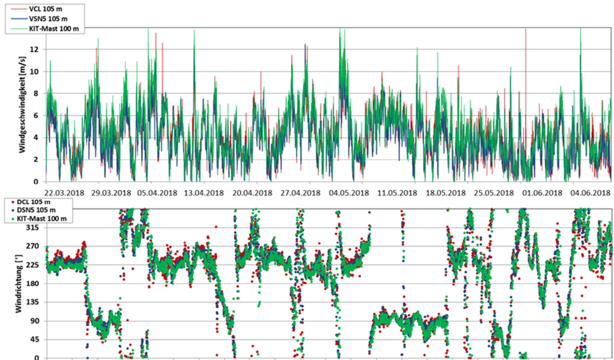
Abbildung 25: Zeitreihe der Windgeschwindigkeit (oben) und Windrichtung (unten) für die Messkampagne am KIT (Mastmessung grün) vom 22.03.-04.06.2019 im Vergleich zu Messungen des SODARs (VCL/DCL: rot, VSN3/DSN3: blau) in 1,2 km Entfernung vom Messmast. Messungen Mast in 100 m Höhe, SODAR 105 m.
