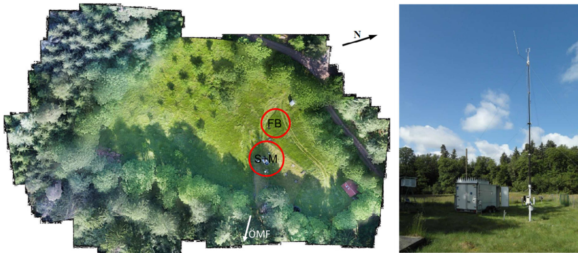
Abbildung 12: Links: Überblick der Lage der Messgeräte auf dem Wildacker Tharandter Wald, FB: Fesselballon, S+M: SODAR und 10 m-Mast (Flug mit unbemanntem Luftfahrzeug am 20.06.2016, Quelle: TUD). Rechts: SODAR und 10-Messmast mit USA (Quelle: TUD).
