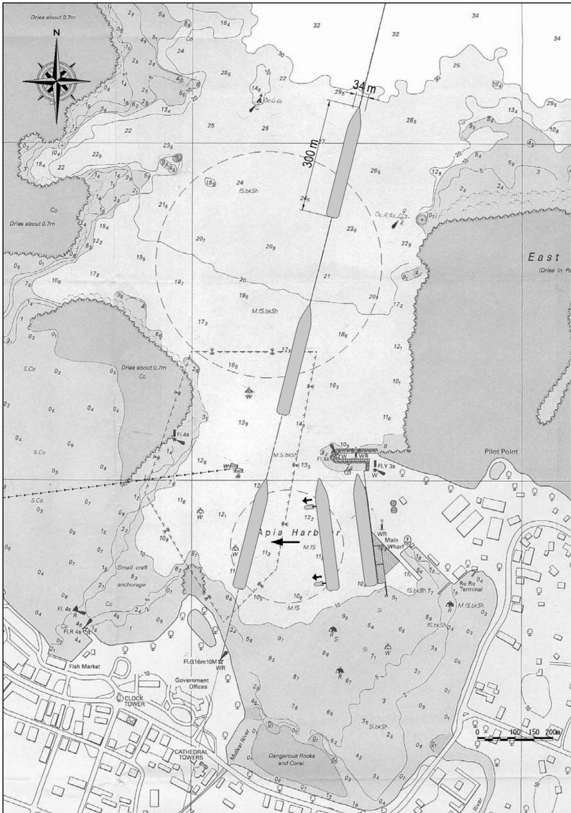
検討図 2-2 クルーズ船出航：出船接岸からの離岸操船
