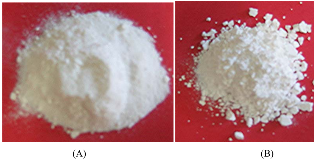
Abbildung 4-4 feinpulvrige Latexpartikel (A), harte Agglomerate von Latexpartikeln (B)
