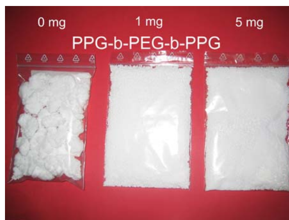
Abbildung 6-12 Polymorphologie bei unterschiedlichen Mengen an Antistatikadditiv
