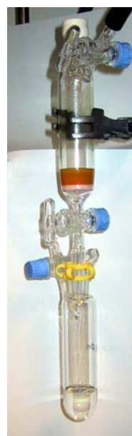
Abbildung 7-3 Schutzgasfritte zum Abfiltrieren der Katalysatorsuspension mit klarem Filtrat
