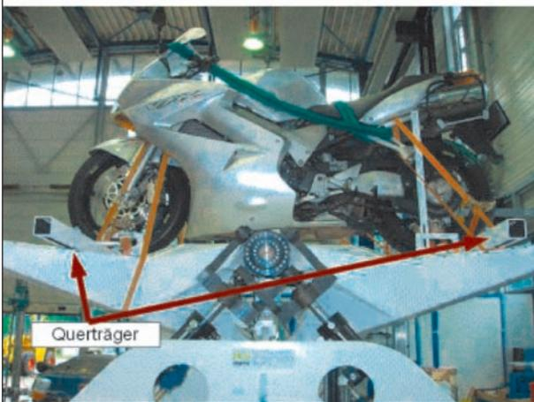
Bild 29: Prinzipskizze Motorradplattform und Messaufbau VIMM (Beladungszustand 1)
