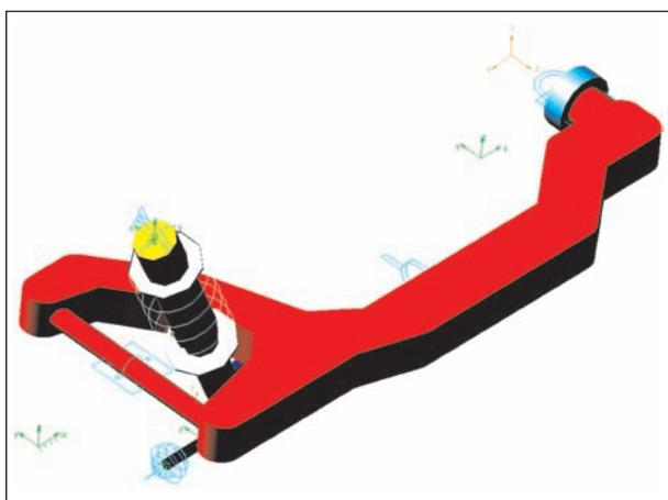
Bild 40: Hinterradaufhängung
