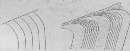
Abbildg. 14. Hakenschlagen von Schichten infolge Gehängedruckes.
