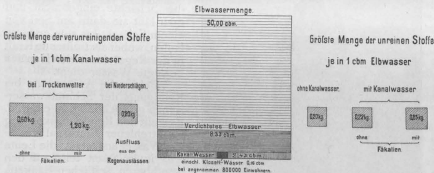
Abbildung 28. Einfluß der Kanalwasser und der darin enthaltenen unreinen Stoffe auf die Elbe bei Niedrigwasser.
