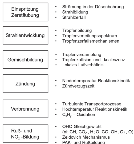
Abbildung 2.1.: Teilprozesse der dieselmotorischen Gemischbildung und Verbrennung [5]
