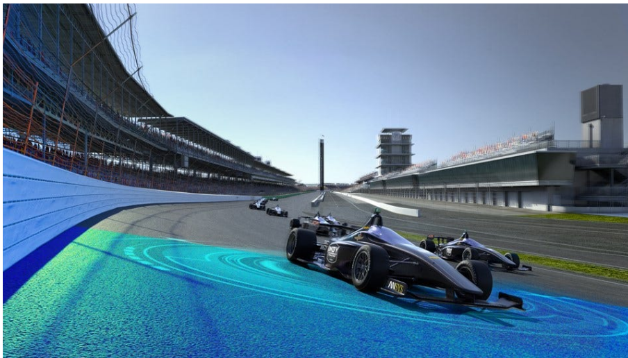
Abbildung 1.1: Das modifizierte Dallara IL-15 Chassis für den autonomen Renneinsatz auf dem Indianapolis Superspeedway im Rahmen der Indy Autonomous Challenge (IAC) [9]
